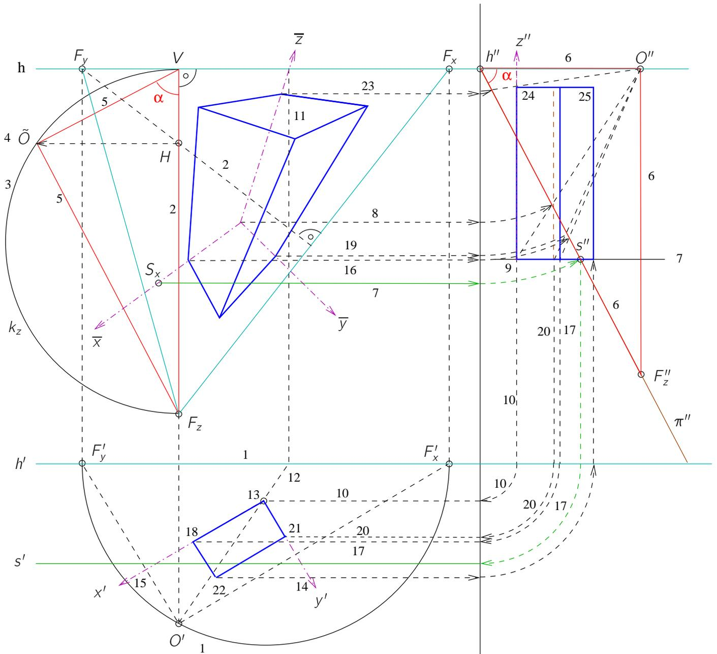
Abbildung 6.29: Zu Abb. 5.63 Rekonstruktion bei geneigter Bildtafel: Grund-, Aufriss eines Quaders
