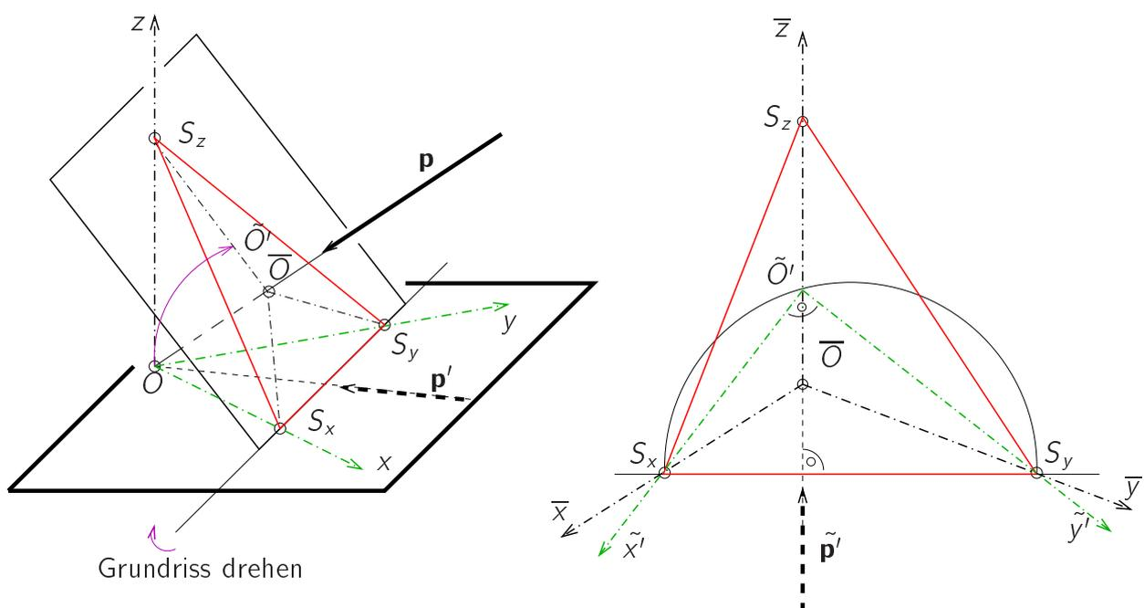
Abbildung 3.32: Senkrechte Axonometrie: Grundriss in die Bildtafel drehen
