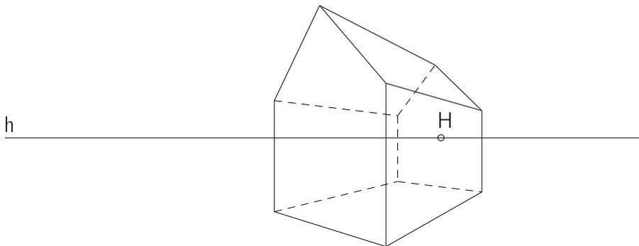
Abbildung 5.9: Fluchtgeraden eines Hauses
