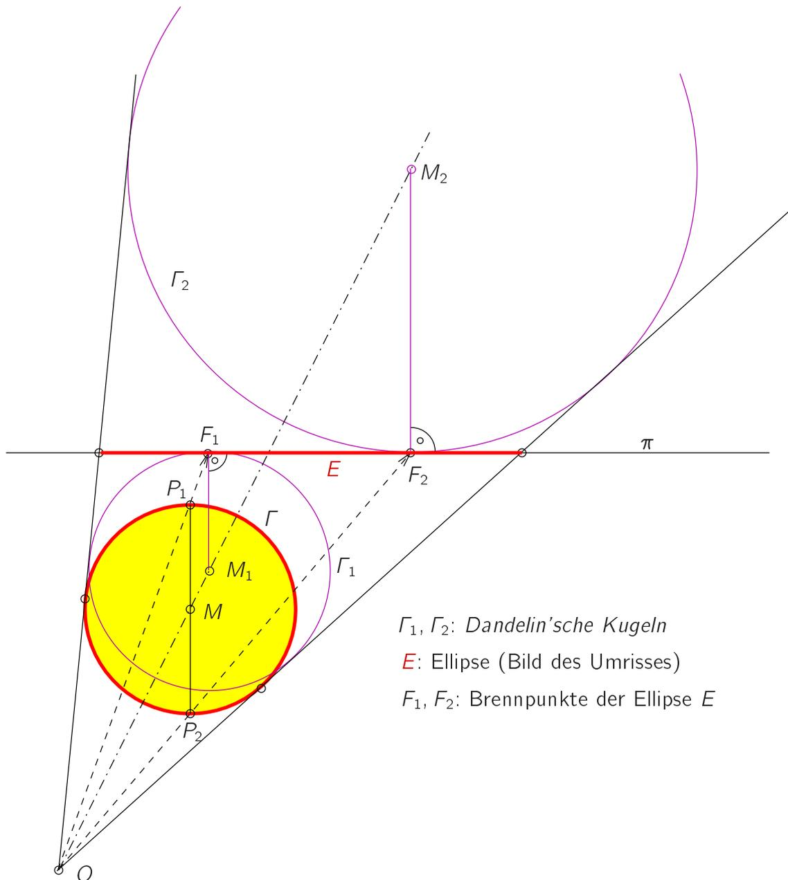
Abbildung 5.82: Projektion des Umrisses einer Kugel als Ellipse: Dandelin'sche Kugeln
