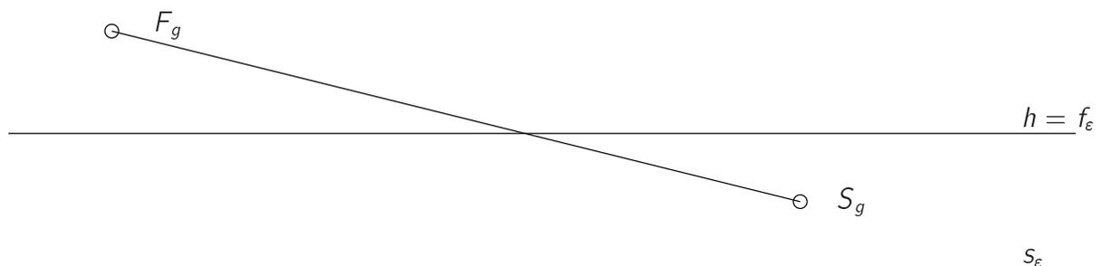
Abbildung 5.27: Spiegelung einer Geraden an der Standebene
