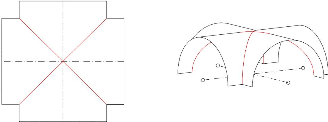
Abbildung 4.36: Kreuzgewölbe (Schnitt zweier Zylinder mit gleichen Radien und sich schneidenden Achsen)
