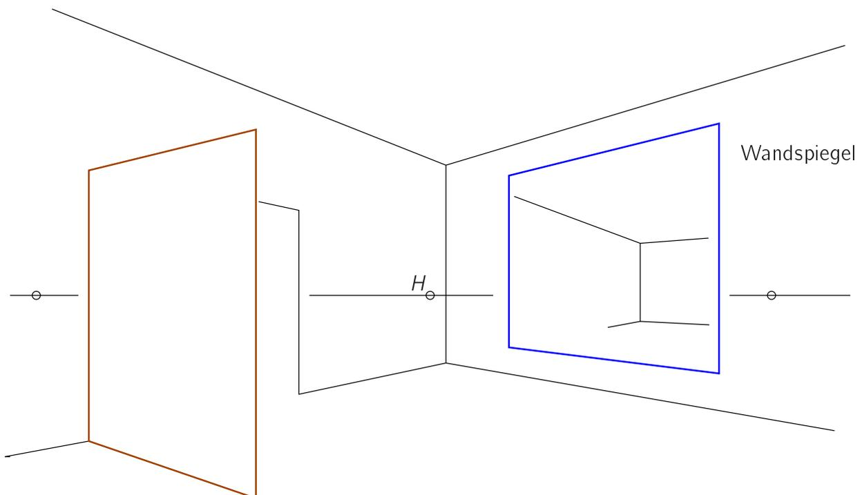
Abbildung 5.30: Spiegelung an einem Wandspiegel
