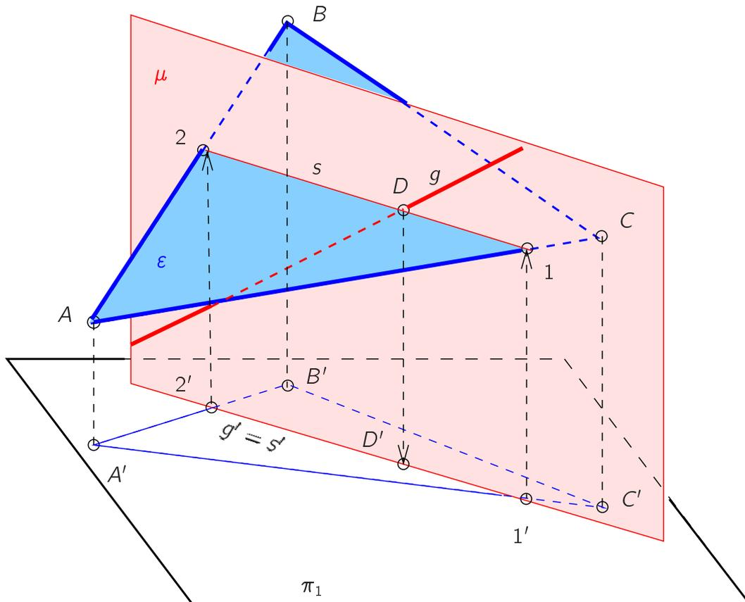
Abbildung 3.22: Schnitt Gerade–Ebene
