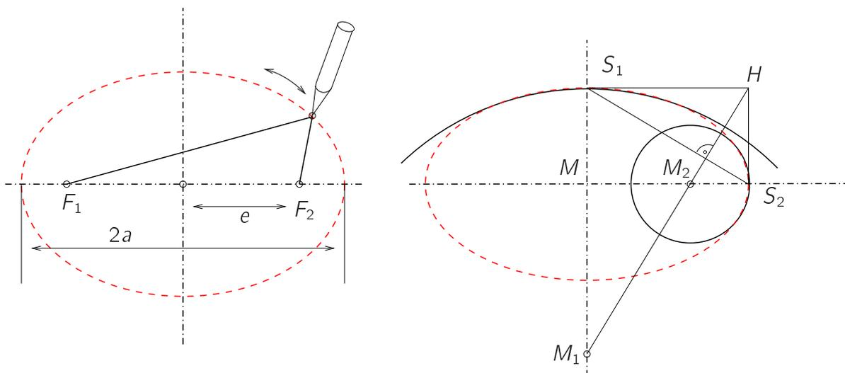
Abbildung 4.4: "Gärtnerkonstruktion" und Scheitel-Krümmungskreise einer Ellipse
