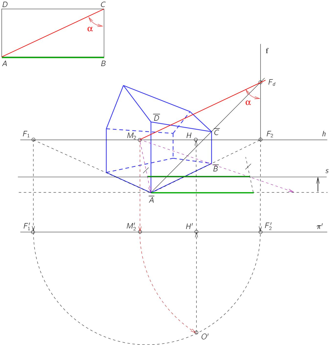
Abbildung 6.27: Zu Abb. 5.58 Rekonstruktion bei einem nicht horizontalen Fluchtpunkt
