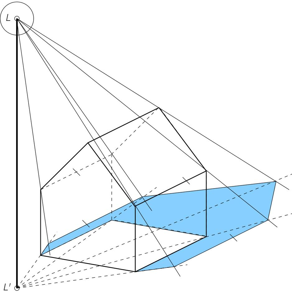
Abbildung 6.4: Zu Abb. 2.14: Schatten eines Hauses bei zentralem Licht
