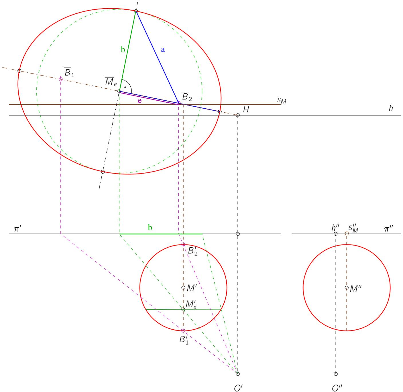
Abbildung 6.36: Zu Abb. 5.84 Projektion des Umrisses einer Kugel als Ellipse
