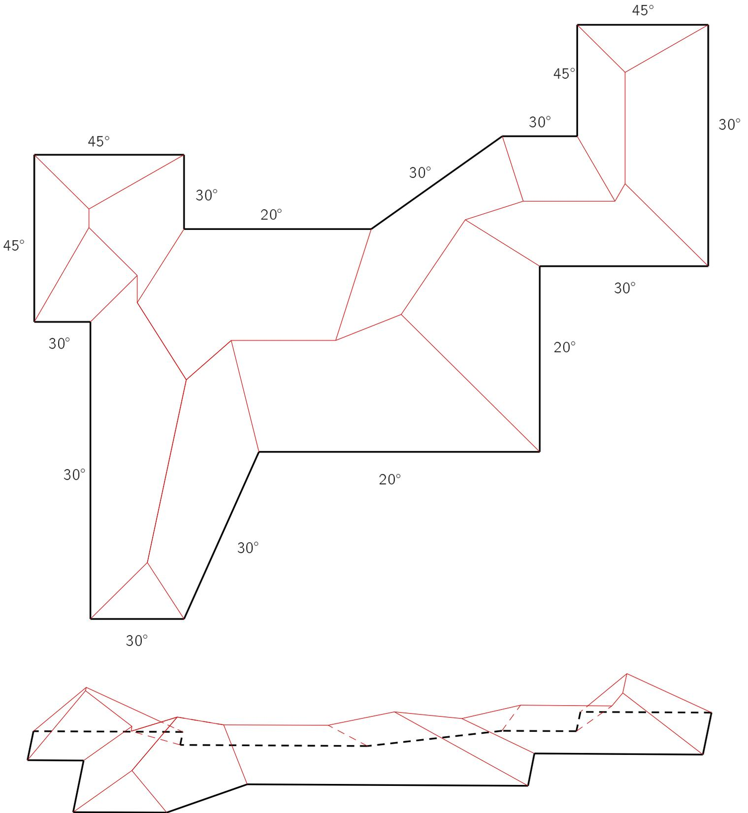
Abbildung 6.9: Zu Abb. 3.41: Lösung von Aufgabe 2 zur Dachausmittlung
