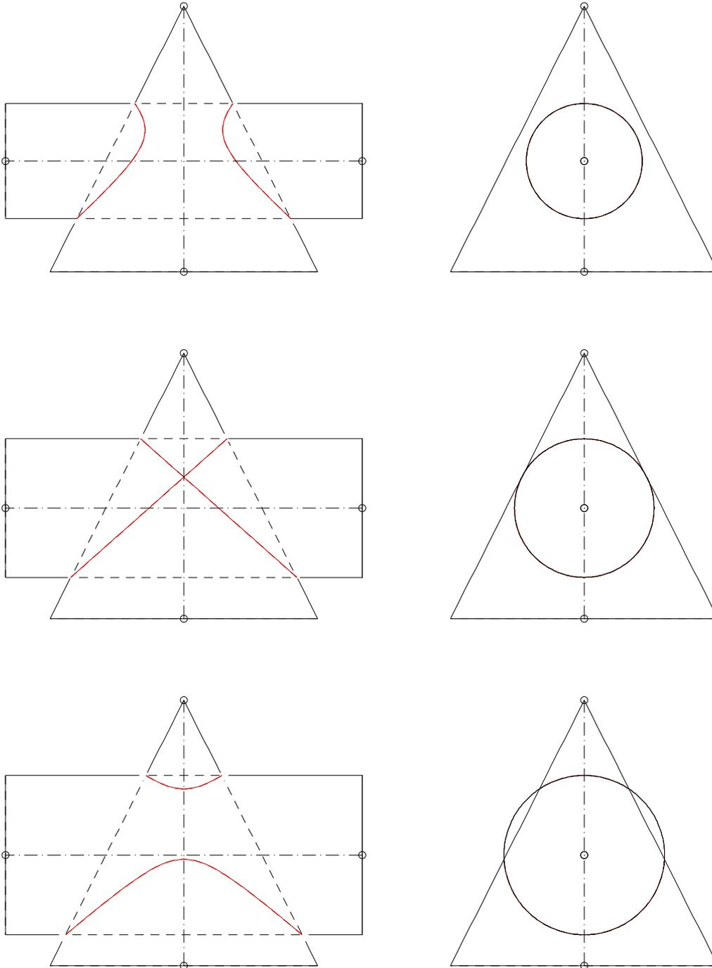
Abbildung 4.35: Schnitt: Kegel-Zylinder (weitere Beispiele)
