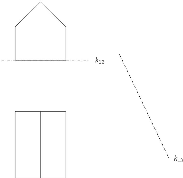
Abbildung 3.18: Umprojektion eines Hauses
