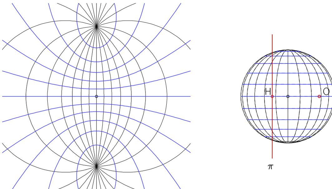
Abbildung 5.88: Zentralprojektion einer Kugel: Augpunkt **in** der Kugel
