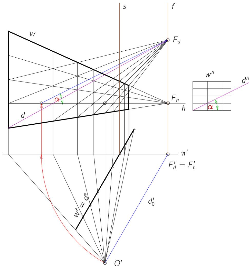
Abbildung 5.21: Fluchtpunkt einer nicht horizontalen Richtung: Diagonalen einer Fensterfront
