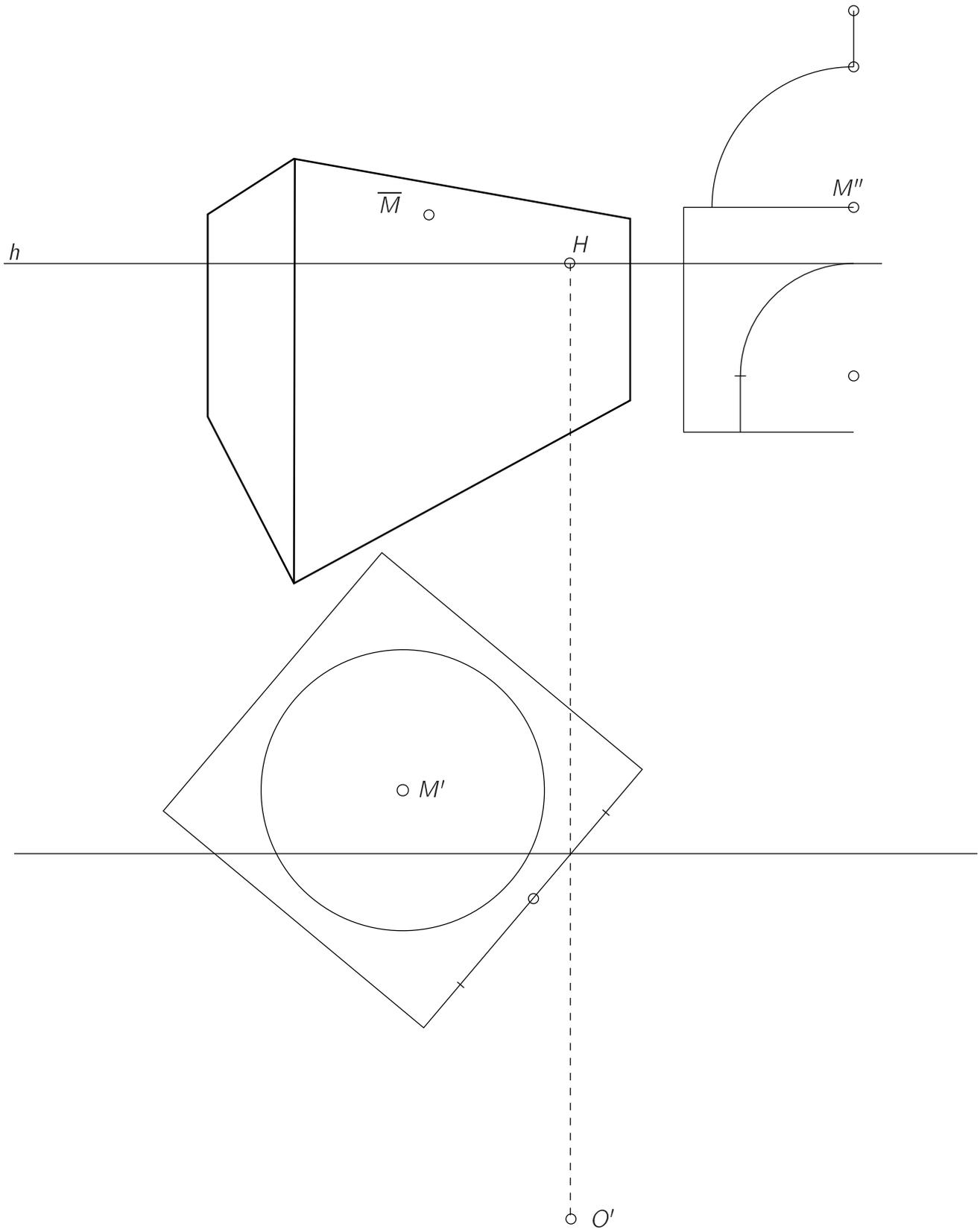
Abbildung 5.90: Projektion von Quader, Kugel und Kreis
