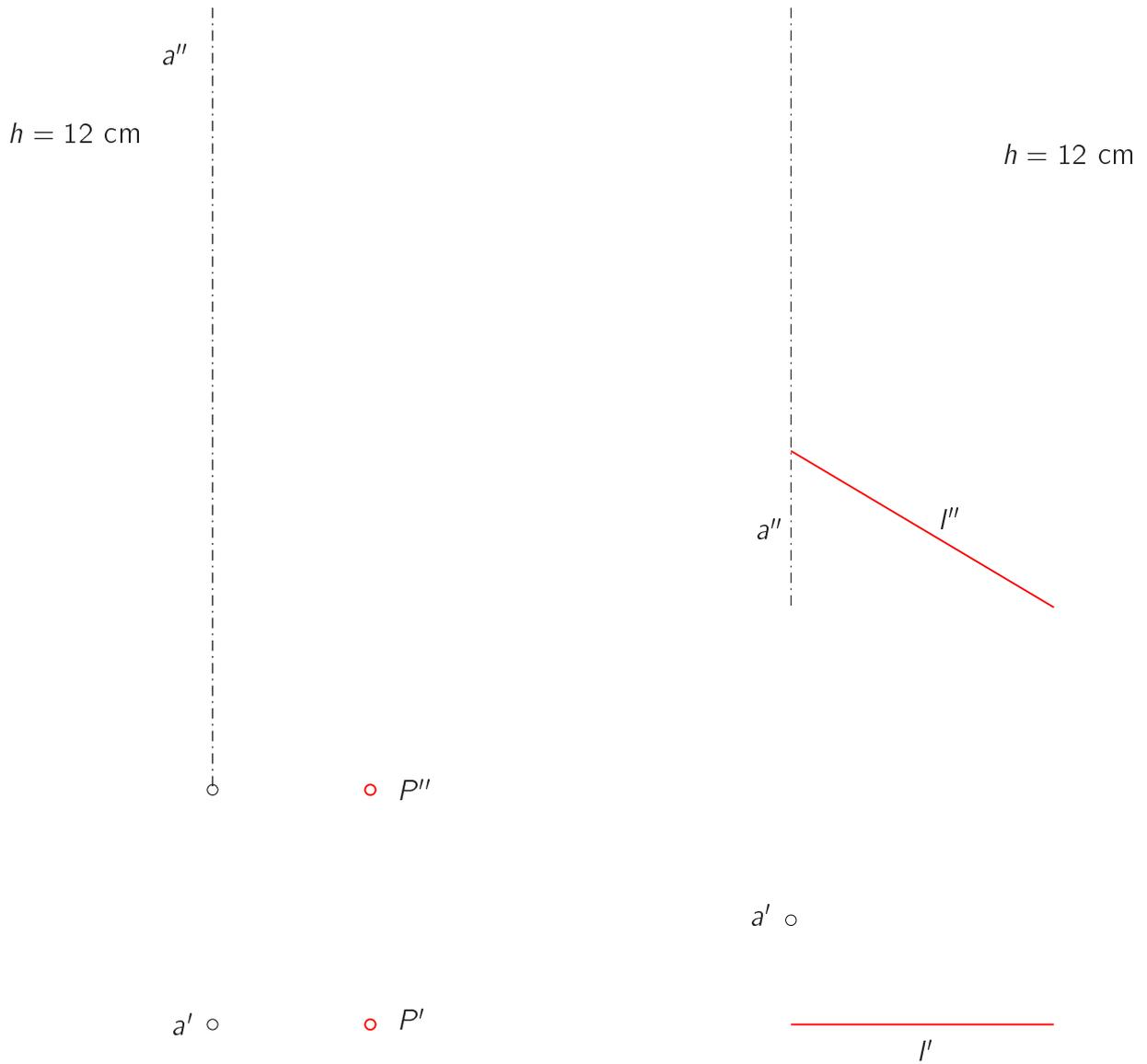
Abbildung 4.21: Verschraubung eines Punktes bzw. einer Strecke
