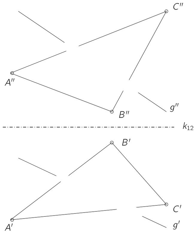
Abbildung 3.23: Schnitt Gerade-Ebene
