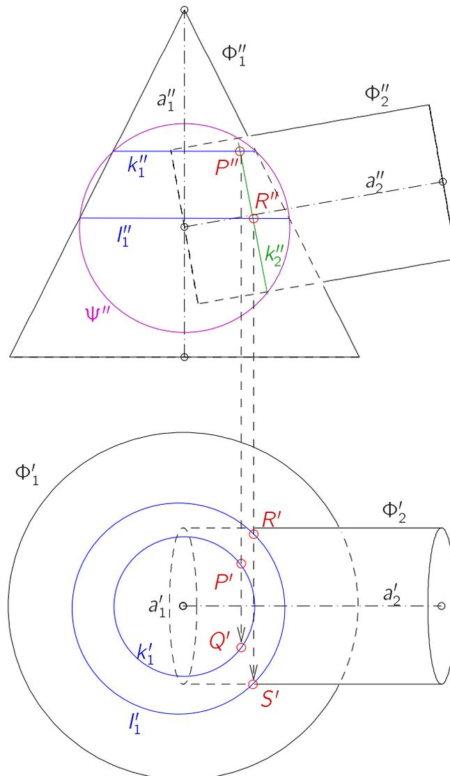
Abbildung 4.33: Schnitt: Kegel–Zylinder (Hilfskugelverfahren)
