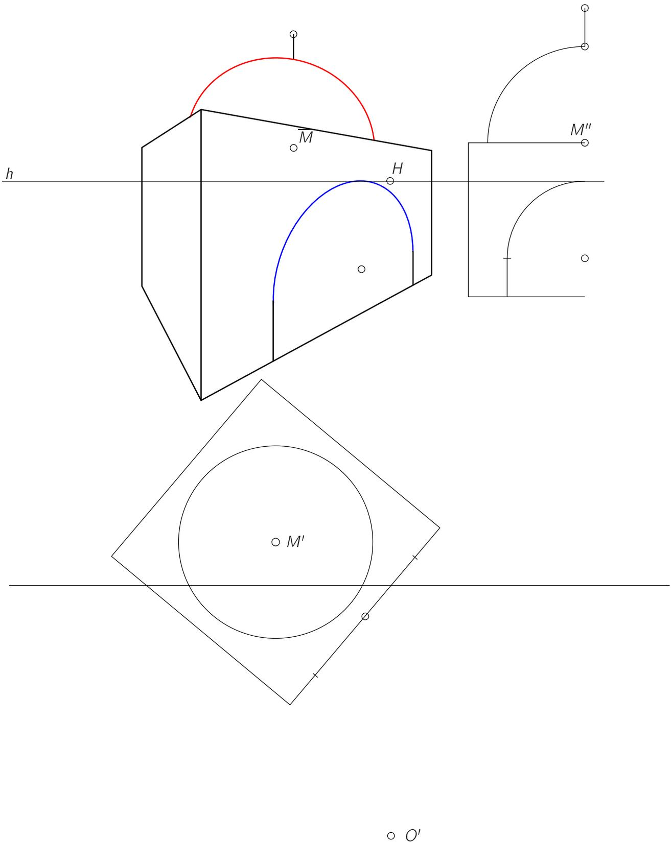
Abbildung 6.41: Zu Abb. 5.90 Projektion von Quader, Kugel und Kreis
