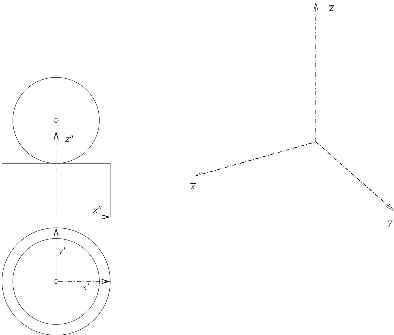
Abbildung 4.11: Zylinder mit Kugel in senkrechter Axonometrie
