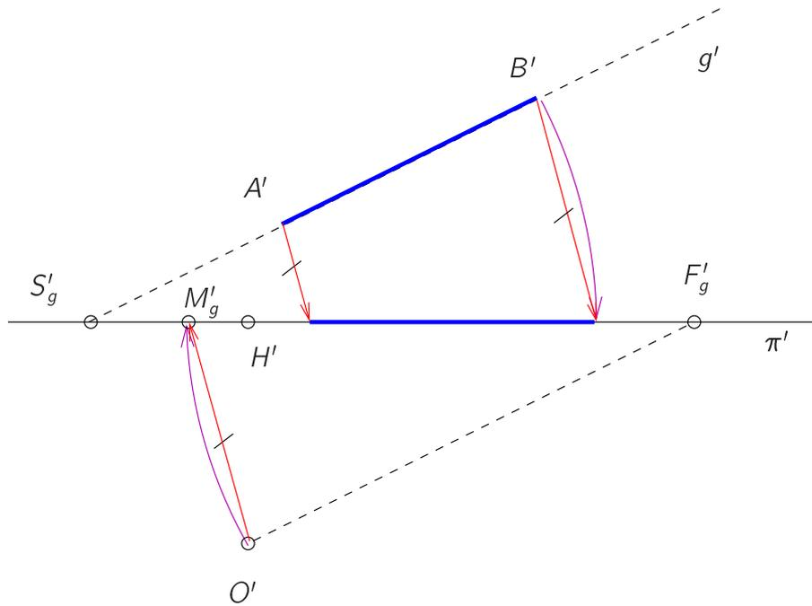
Abbildung 5.44: Bestimmung der wahren Länge einer horizontalen Strecke
