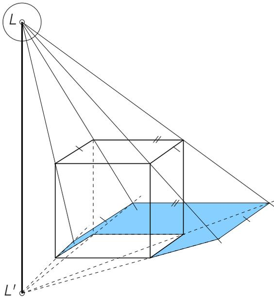
Abbildung 6.3: Zu Abb. 2.13: Schatten eines Quaders bei zentralem Licht
