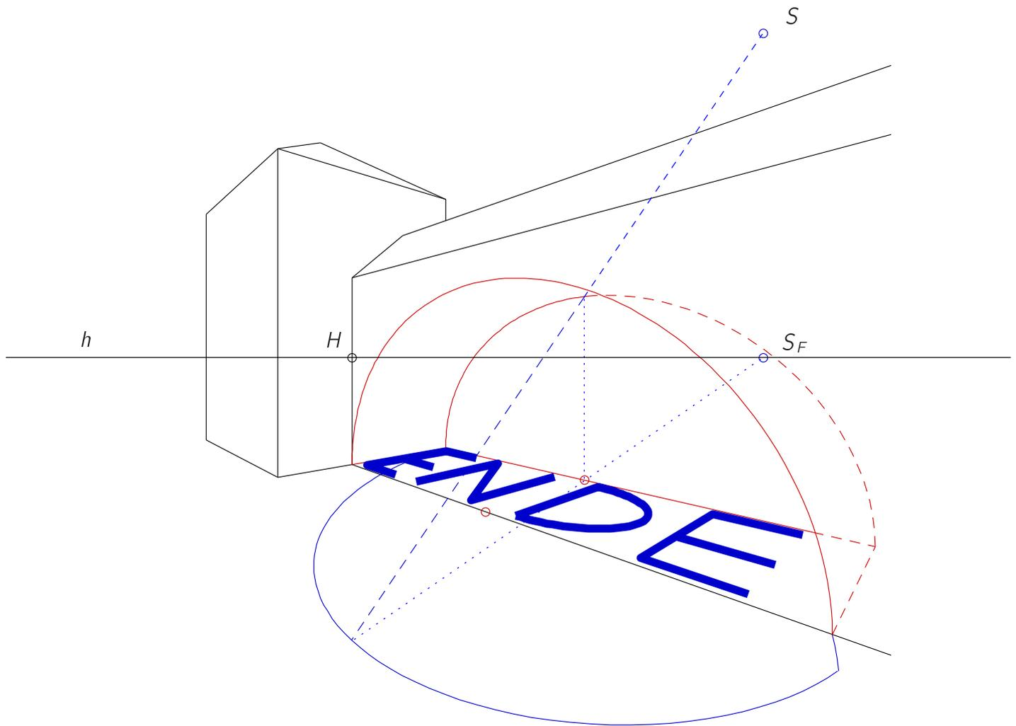
Abbildung 6.45: Zu Abb. 5.92: Schatten eines Torbogens bei gegebenem Sonnenlicht
