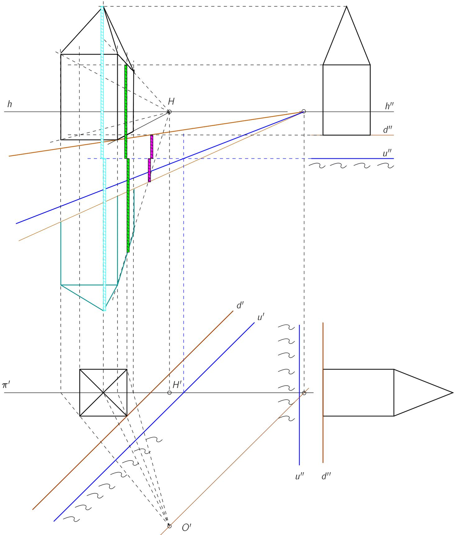
Abbildung 6.15: Zu Abb. 5.28: Spiegelung eines Quaders an einer Wasseroberfläche: Lösung
