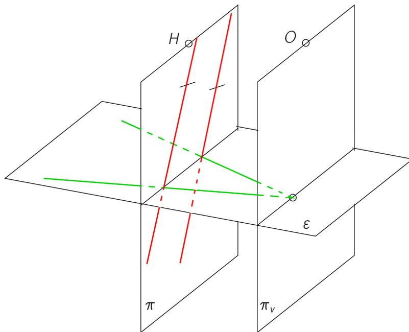
Abbildung 5.75: Urbilder paralleler Geraden in der Standebene
