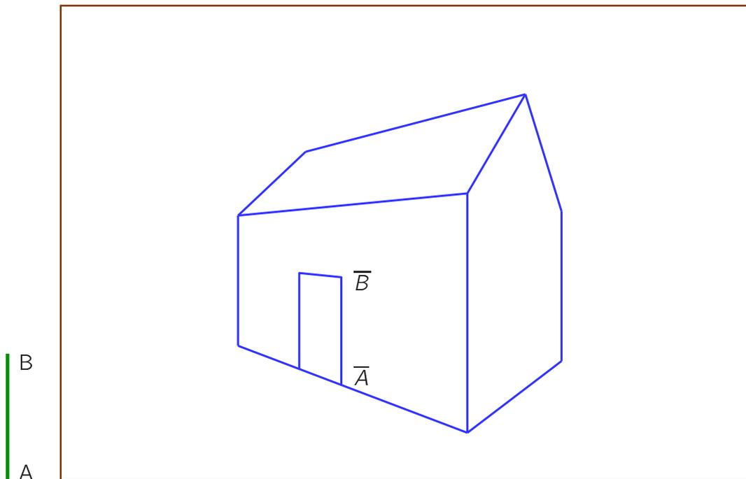
Abbildung 5.53: Rekonstruktion von Grund- und Aufriss eines Hauses aus einer Photographie
