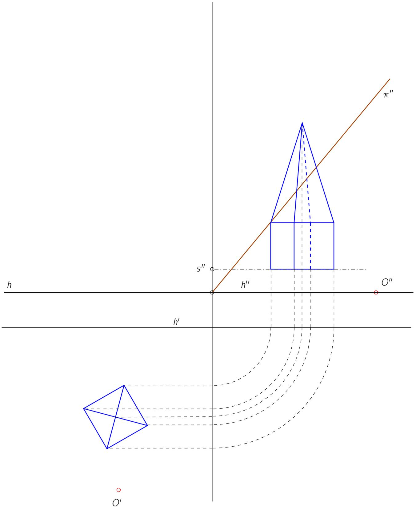
Abbildung 5.42: Zentralprojektion bei geneigter Bildtafel: Turm
