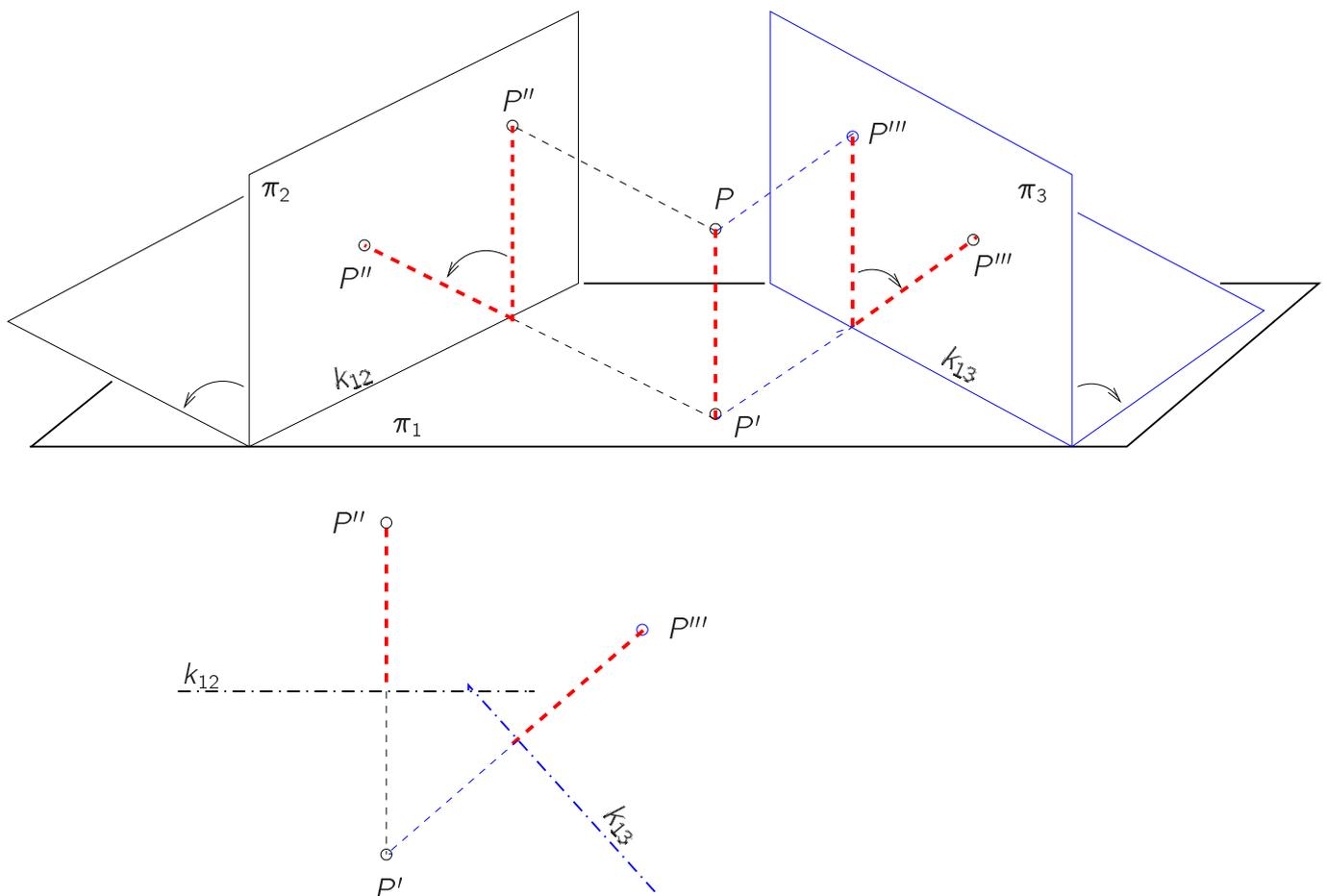
Abbildung 3.17: Umprojektion eines Punktes
