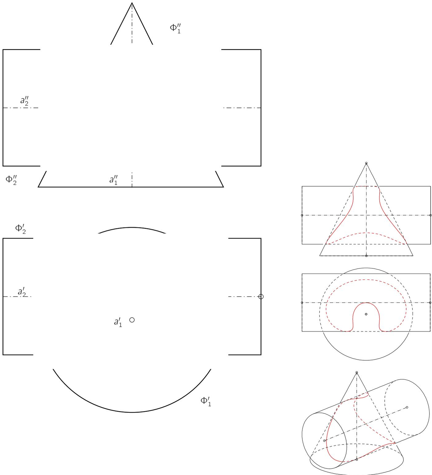
Abbildung 4.32: Schnitt: Kegel–Zylinder (Hilfsebenenverfahren)
