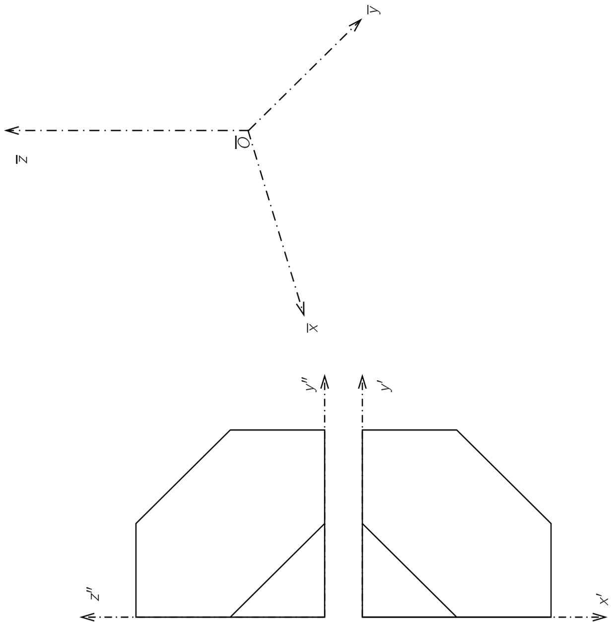
Abbildung 3.35: Senkrechte Axonometrie: Beispiel "halber" Würfel
