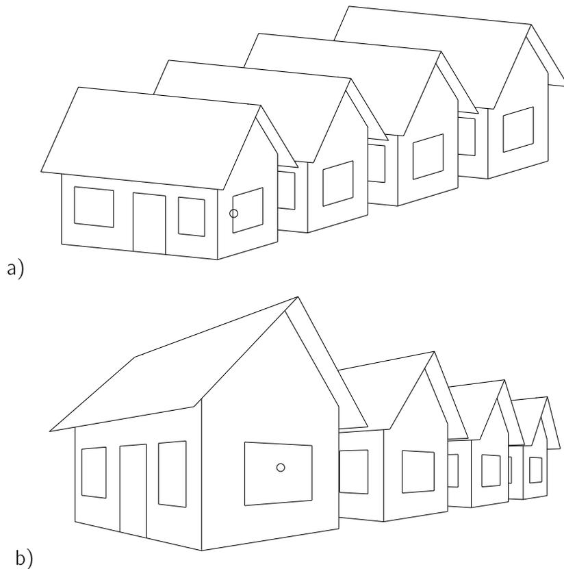
Abbildung 1.5: Häuser in a) Parallelprojektion b) Zentralprojektion
