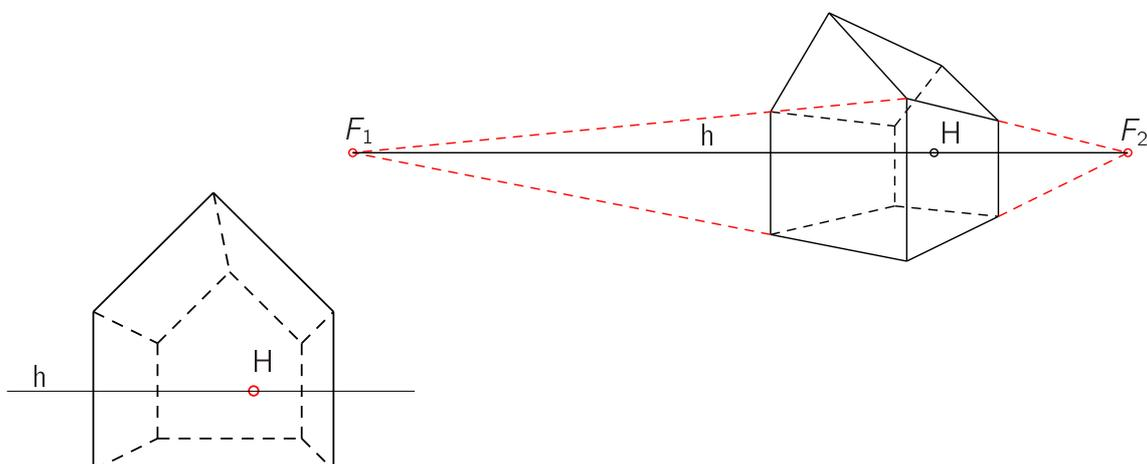
Abbildung 5.7: Fluchtpunkte eines Hauses
