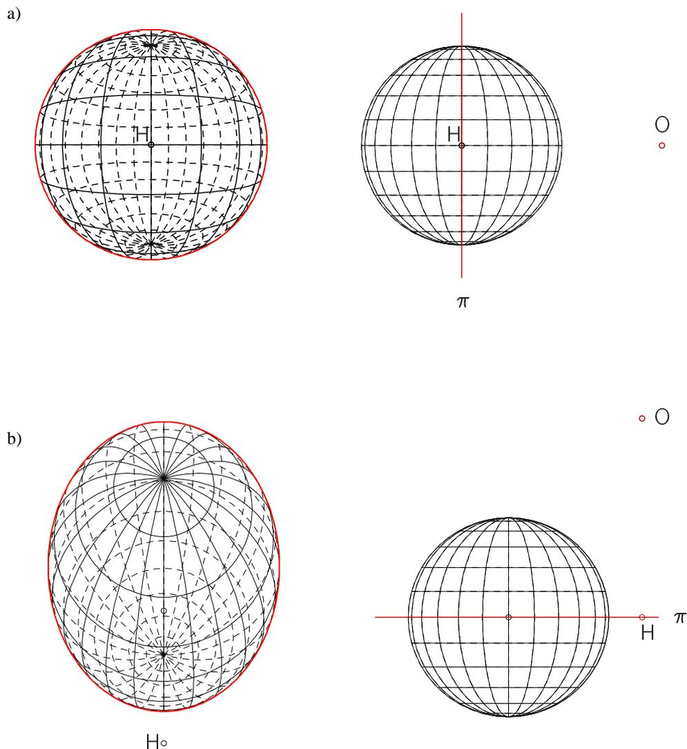
Abbildung 5.86: Zentralprojektion einer Kugel: Zentrum außerhalb der Kugel a) horizontale b) vertikale Sicht
