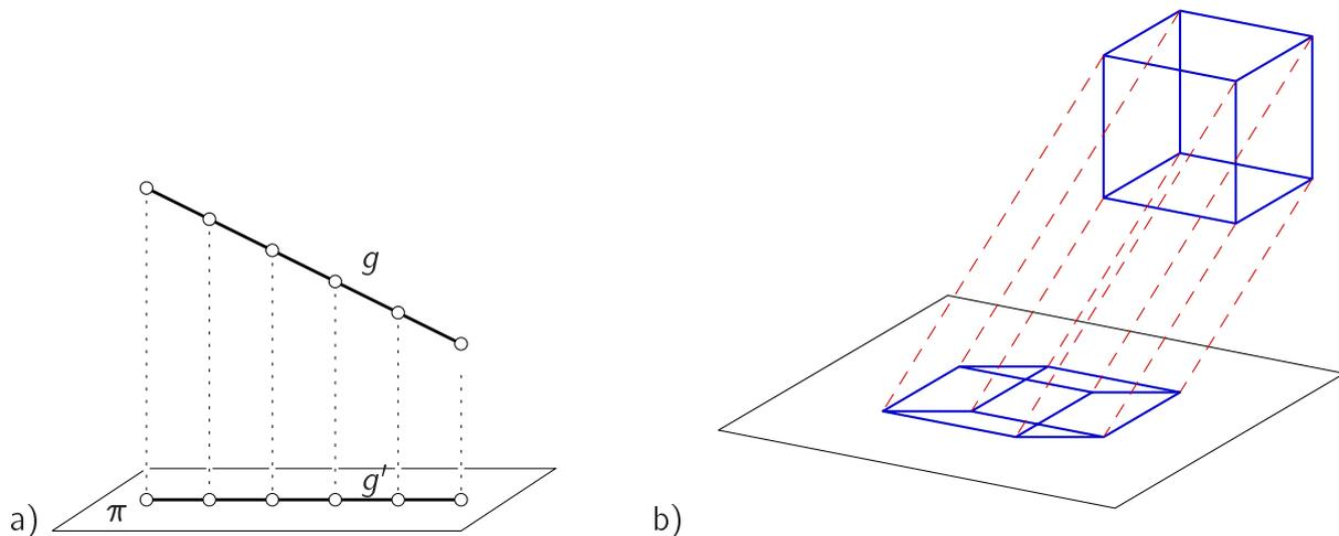
Abbildung 1.9: a) Teilverhältnistreue der Parallelprojektion b) In Vogelperspektive bleiben Deckel und Boden des Quaders unverzerrt, während die vier vertikalen Kanten im gleichen Maß verzerrt sind (s. auch Abb. 1.3).
