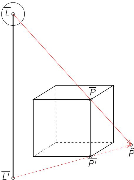
Abbildung 2.13: Schatten eines Quaders bei zentralem Licht
