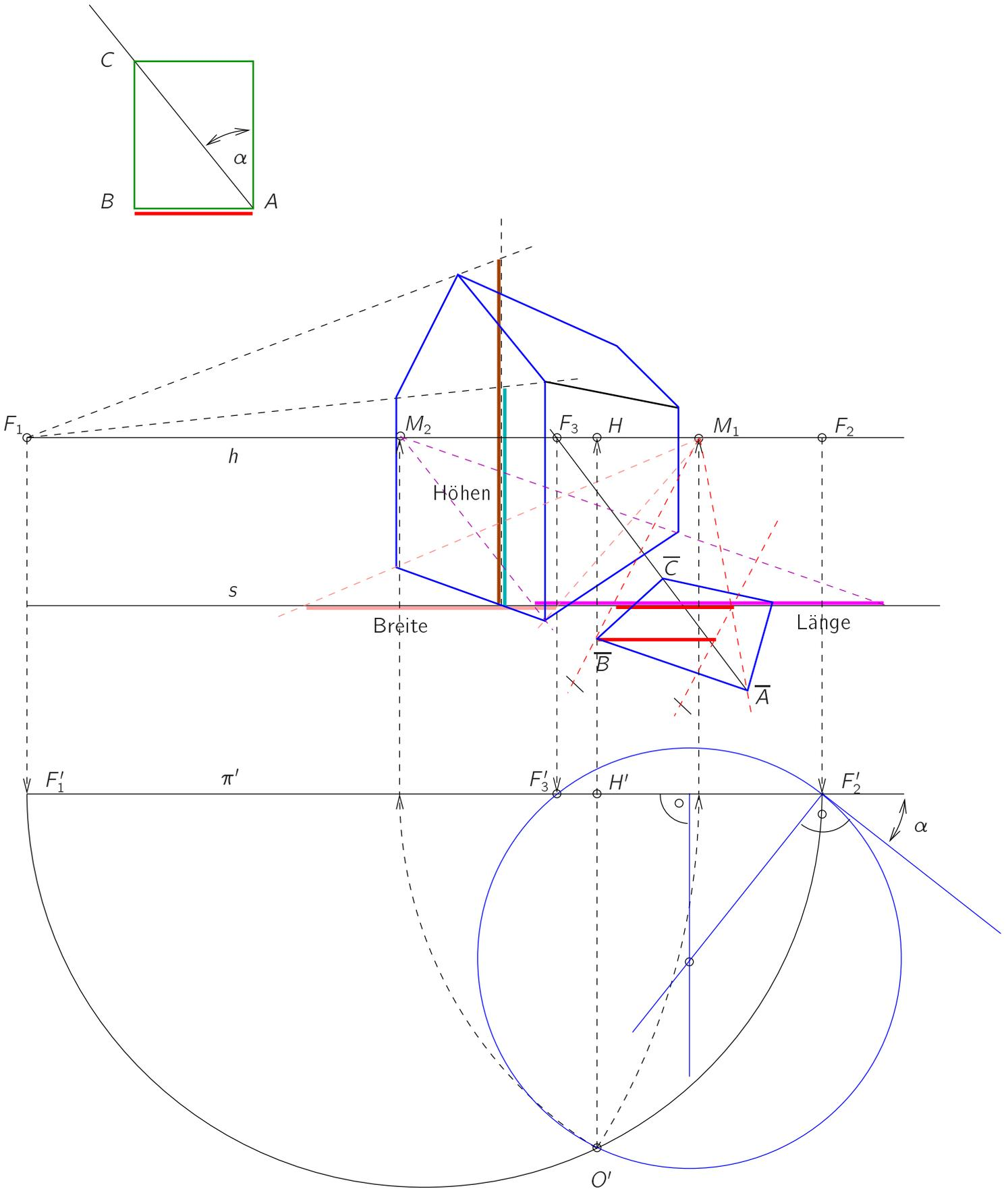
Abbildung 6.26: Zu Abb. 5.57 Rekonstruktion bei 3 horizontalen Fluchtpunkten: Beispiel
