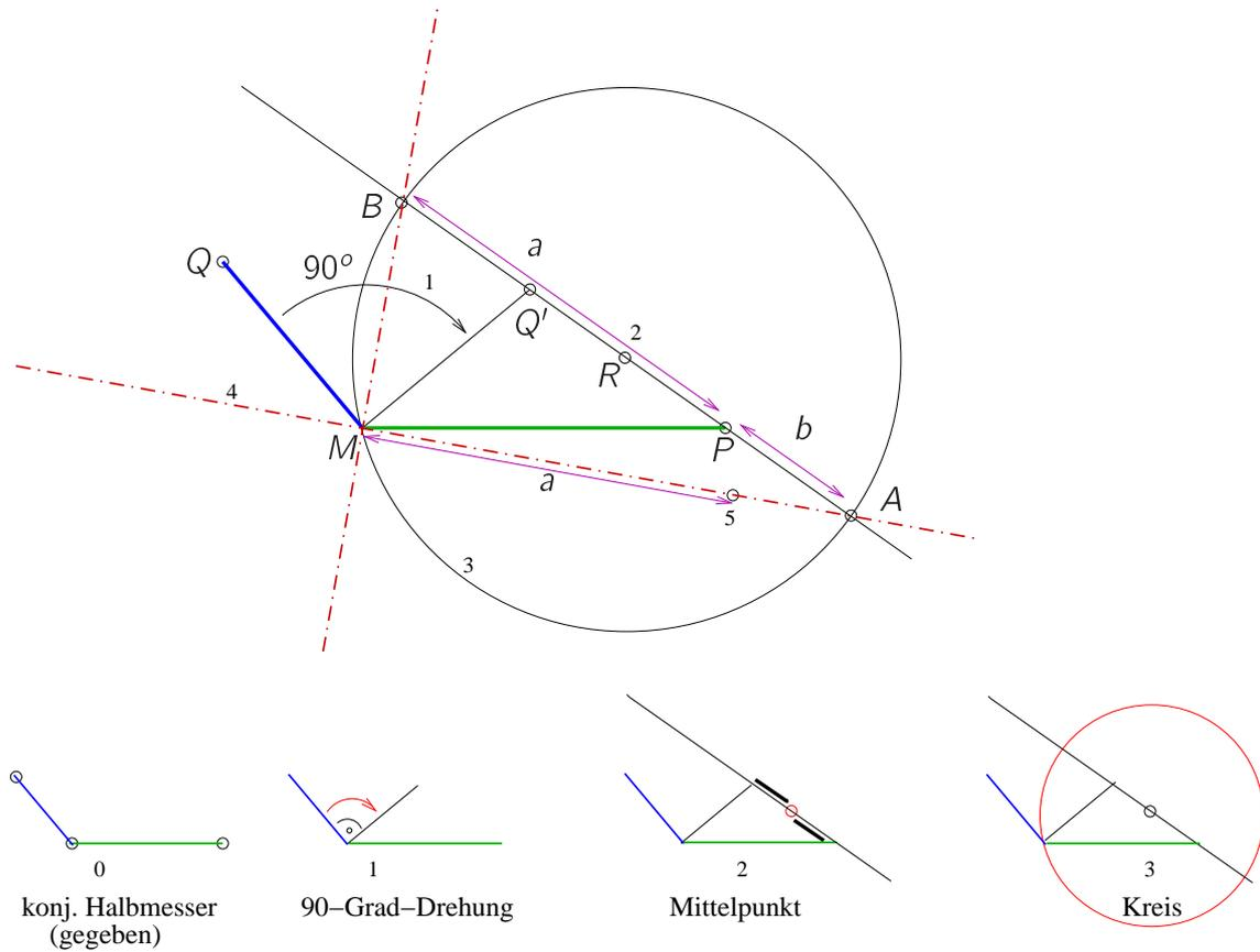
Abbildung 4.7: Rytz-Konstruktion
