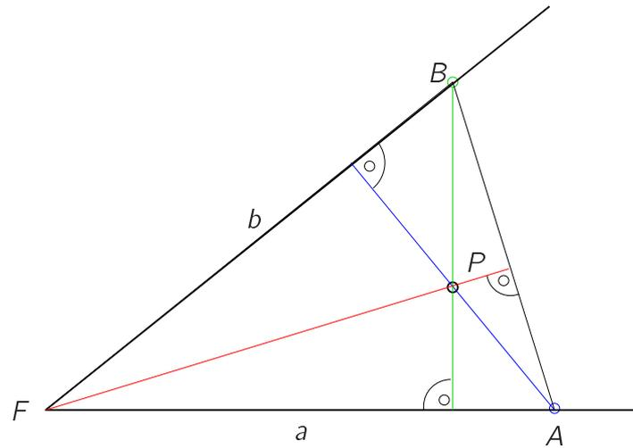
Abbildung 5.22: Gerade durch unerreichbaren Fluchtpunkt
