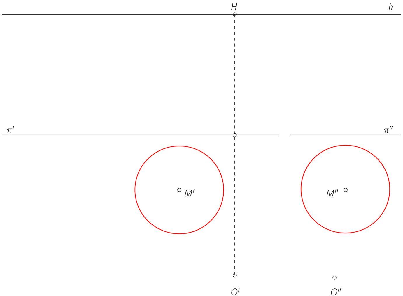
Abbildung 5.84: Projektion des Umrisses einer Kugel als Ellipse
