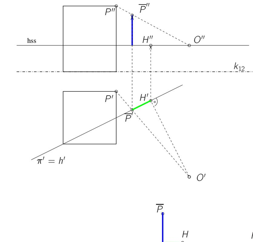
Abbildung 5.10: Zentralprojektion eines Quaders mit der Durchstoßpunktmethode
