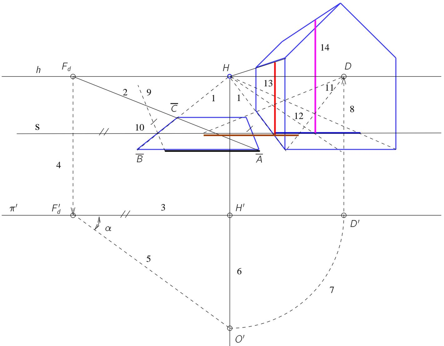
Abbildung 6.25: Zu Abb. 5.54: Wahre Abmessungen eines Hauses bei bekanntem Vorgarten
