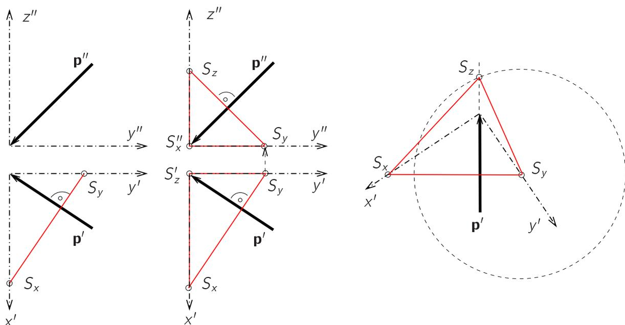
Abbildung 3.33: Konstruktion des Spurdreiecks aus der Projektionsrichtung
