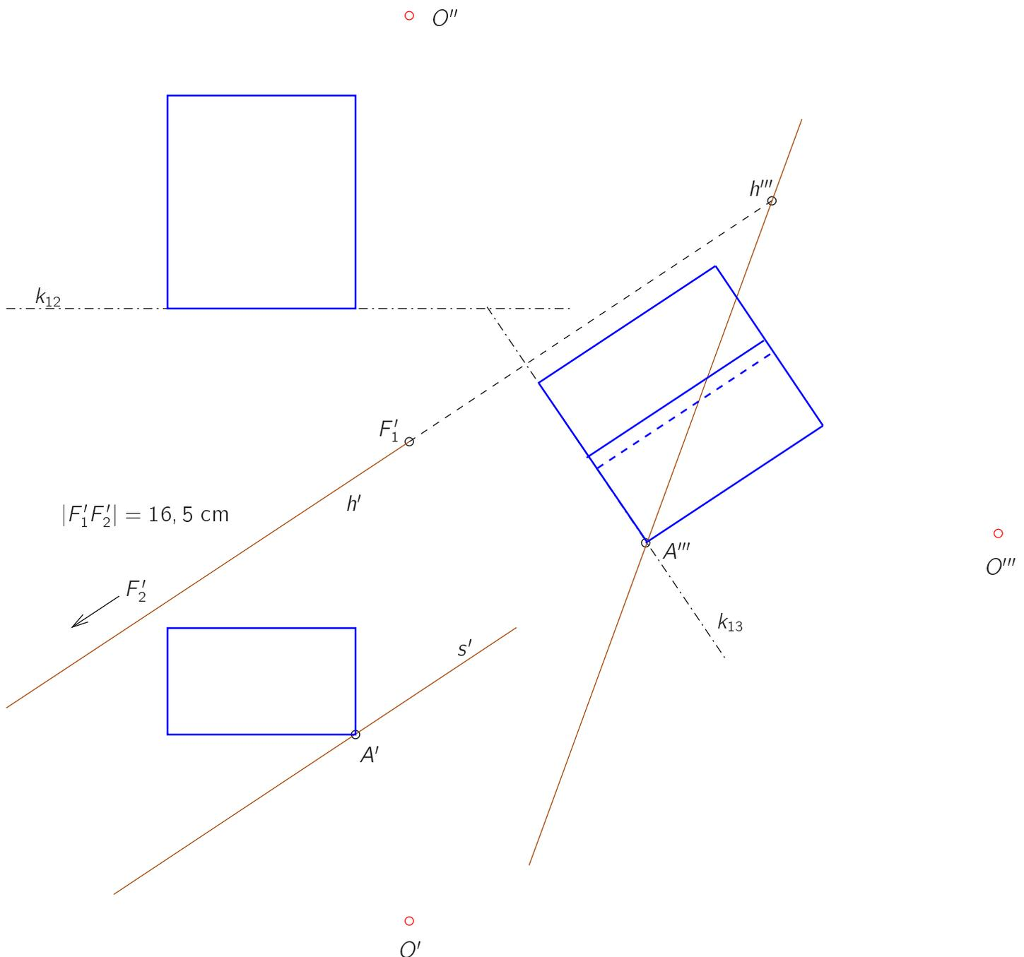
Abbildung 5.38: Zentralprojektion bei geneigter Bildtafel
