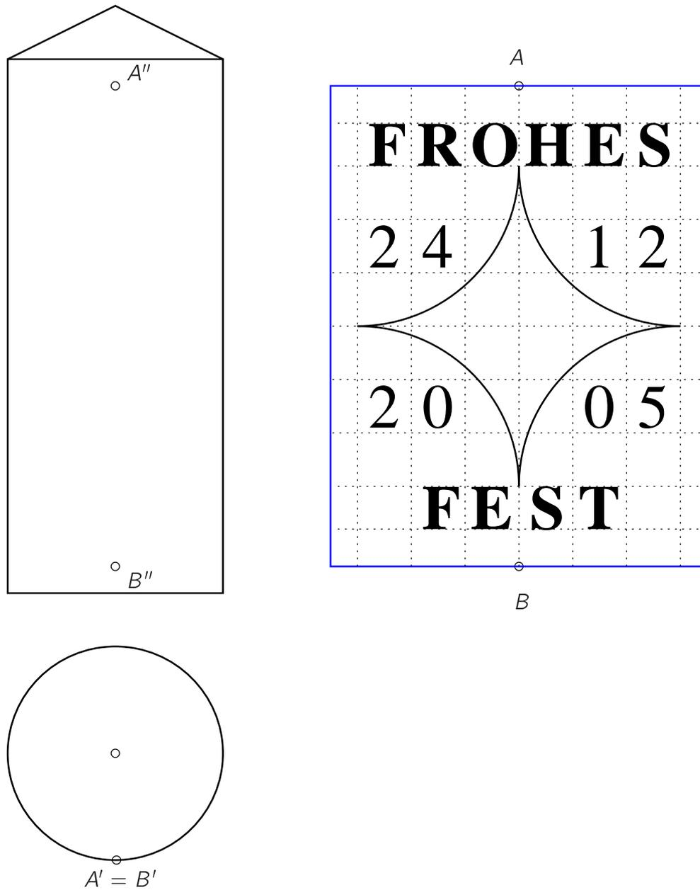
Abbildung 4.18: Aufwicklung auf einen Zylinder
