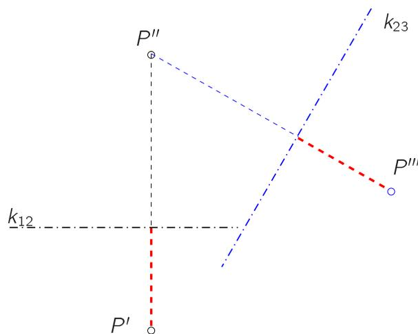
Abbildung 3.19: Umprojektion eines Punktes (Grundriss wird ersetzt)
