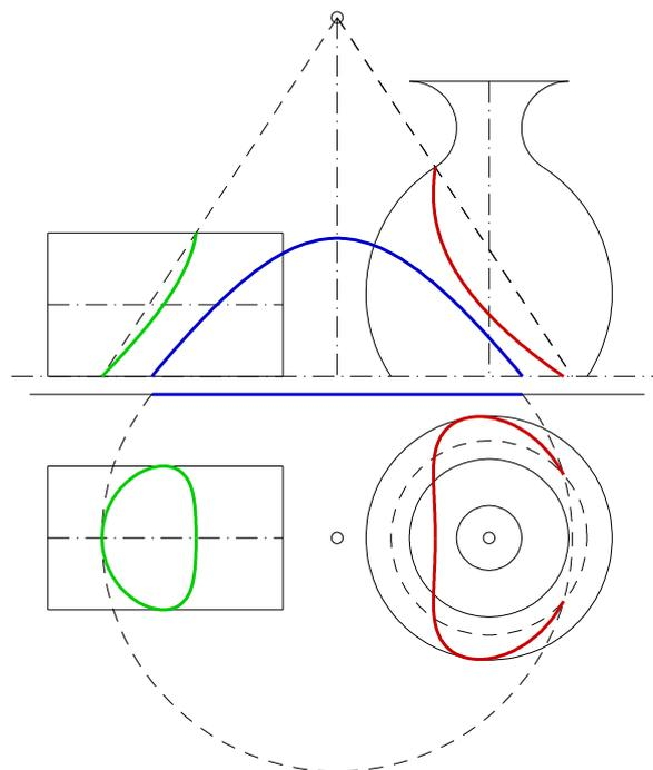
Abbildung 4.37: Durchdringungskurven: Lösung zu Abb. 4.38
