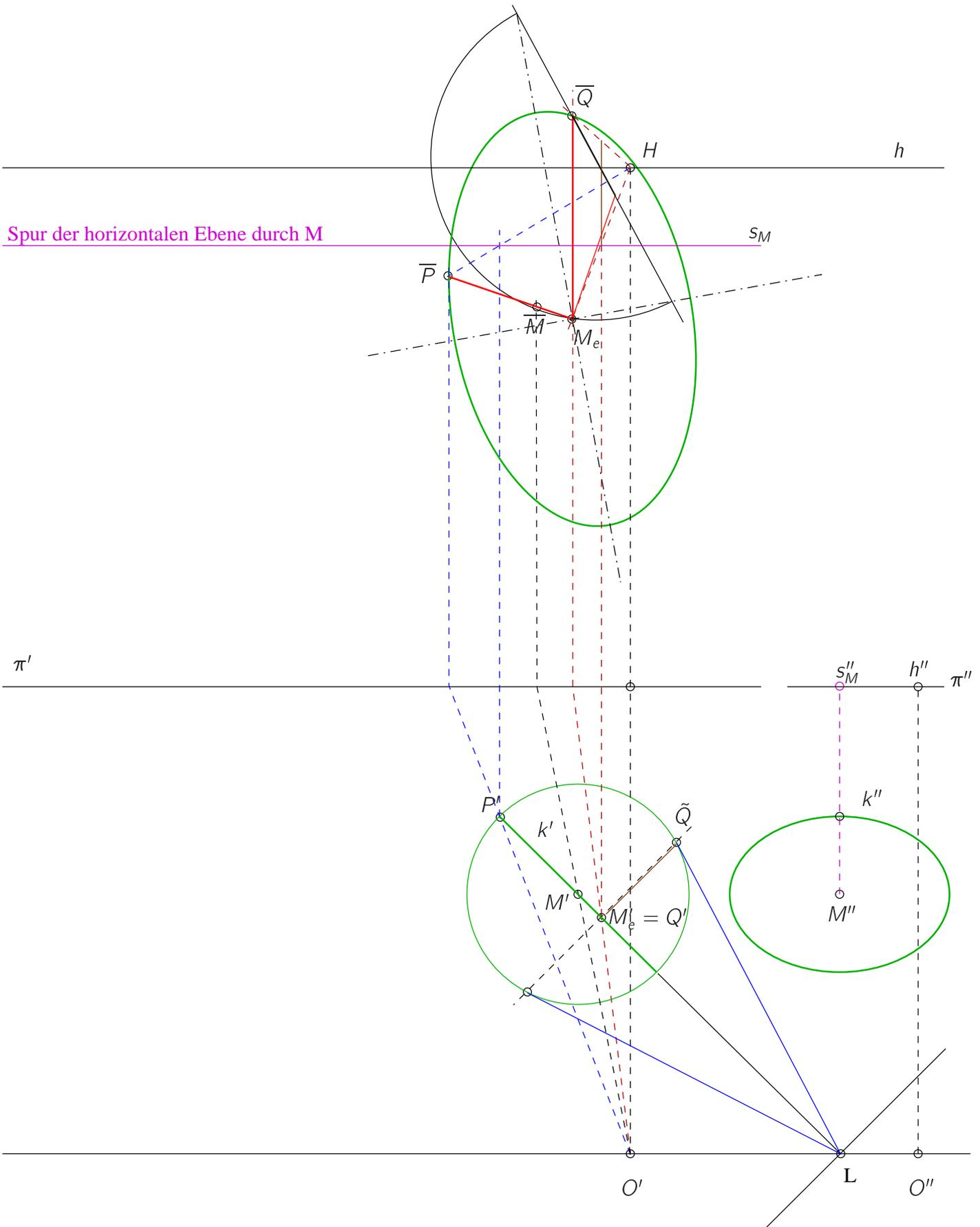
Abbildung 6.34: Zu Abb. 5.80 Projektion eines Kreises senkrecht zur Standebene als Ellipse
