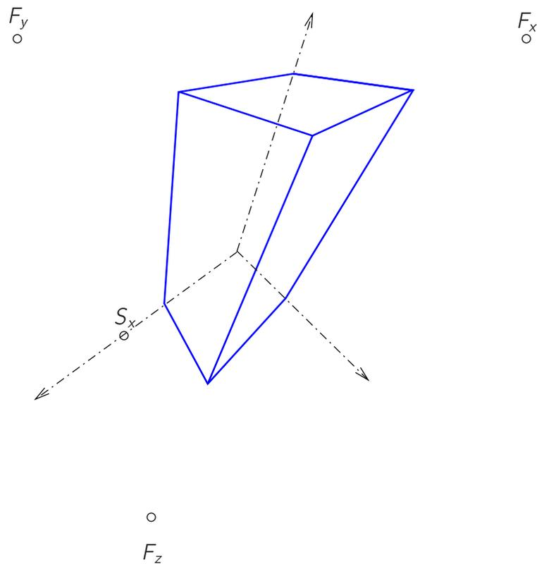
Abbildung 5.61: Rekonstruktion bei geneigter Bildtafel: Wahre Abmessungen eines Quaders
