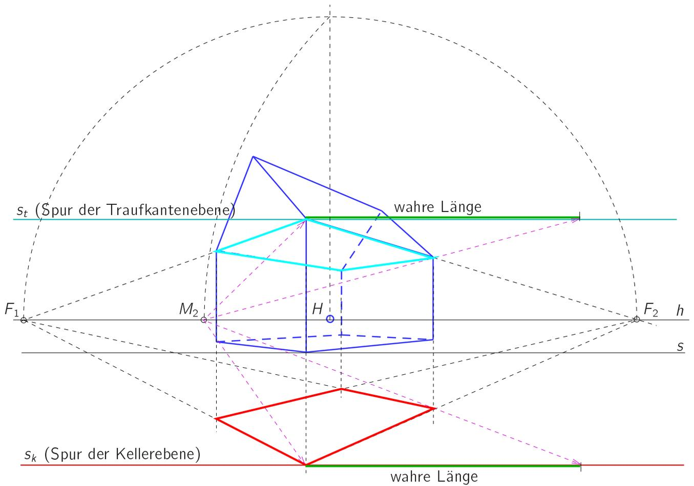
Abbildung 6.22: Wahre Länge eines Hauses mit dem Keller-/Traufkantengrundriss
