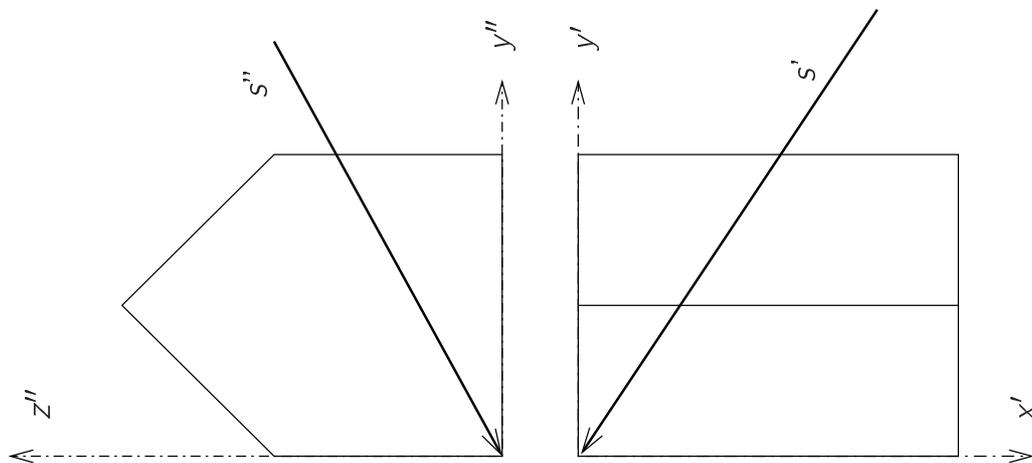
Abbildung 3.36: Senkrechte Axonometrie: Haus mit vorg. Projektionsrichtung
