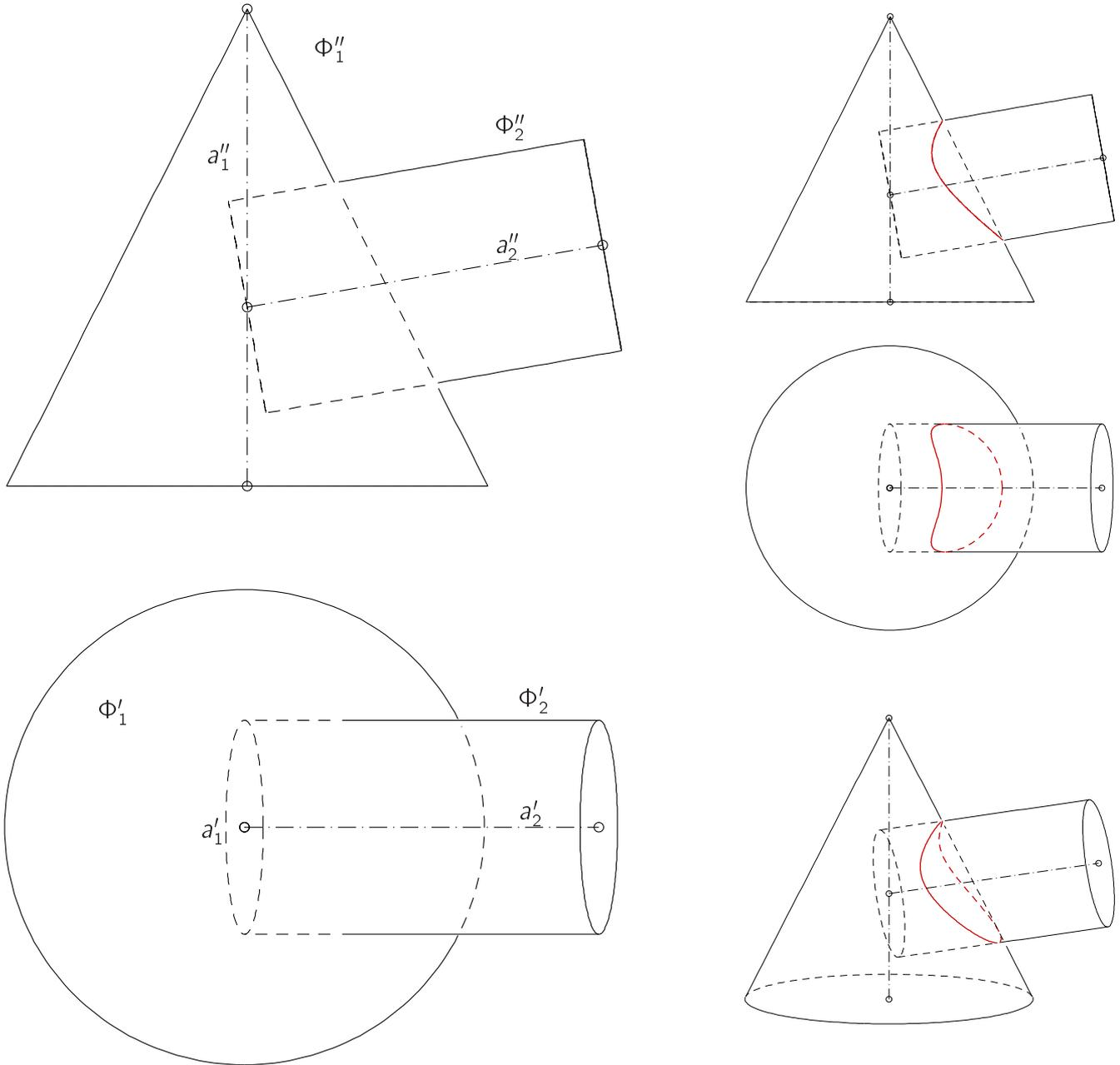
Abbildung 4.34: Schnitt: Kegel-Zylinder (Hilfskugelverf.)
