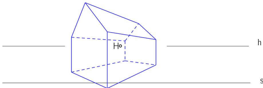
Abbildung 5.43: Beispiel zu *wahre Abmessungen* eines Hauses
