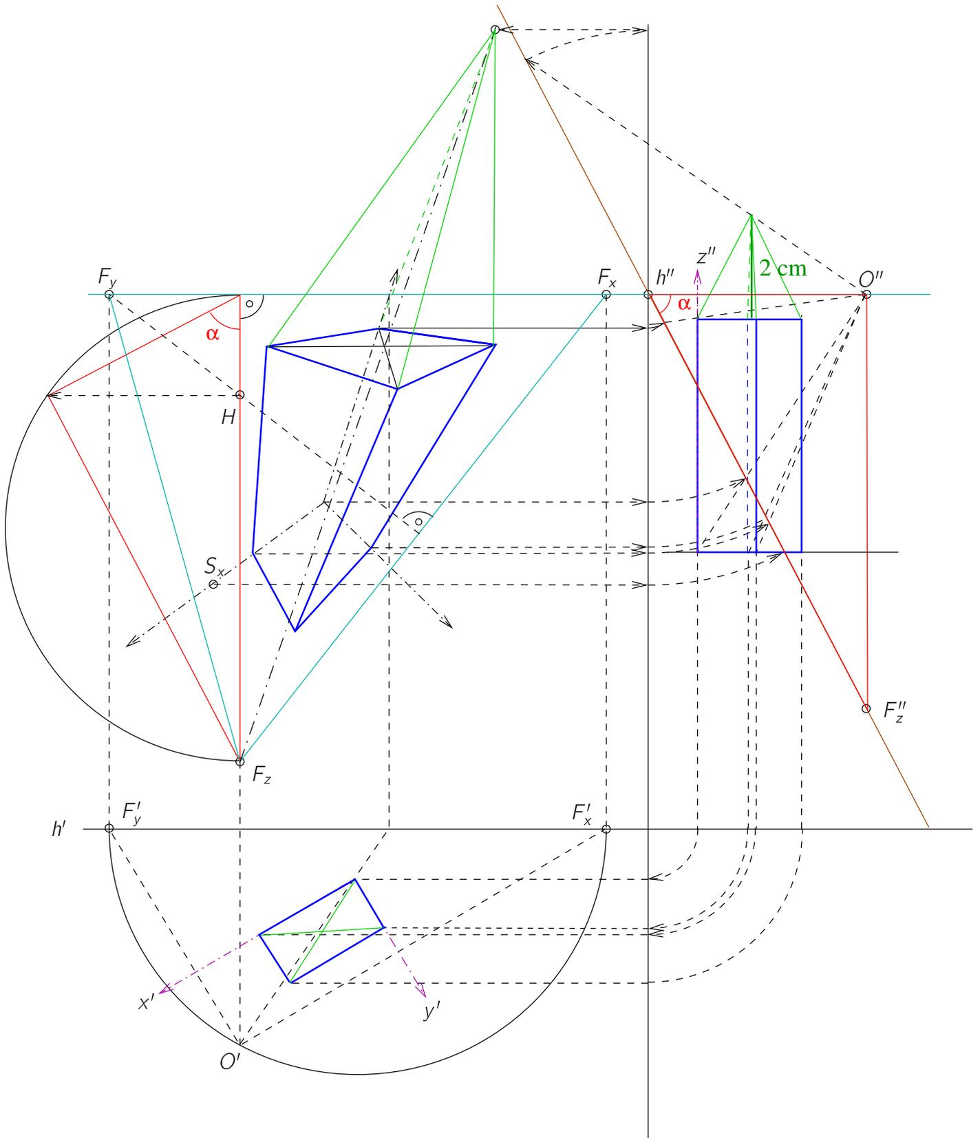
Abbildung 6.30: Zu Abb. 5.63 Rekonstruktion bei geneigter Bildtafel: Grund-, Aufriss eines Quaders
