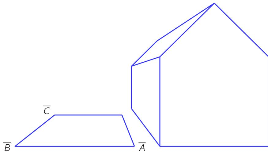
Abbildung 5.54: Wahre Abmessungen eines Hauses bei bekanntem Vorgarten
