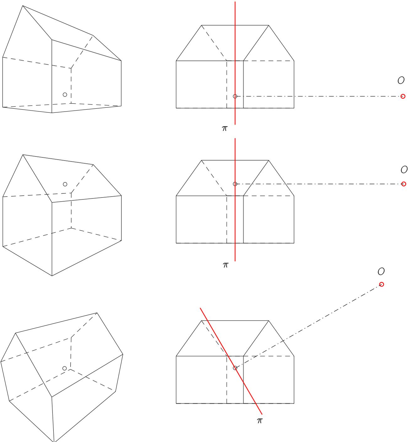
Abbildung 5.14: Wirkung der Wahl von Hauptpunkt und Distanz bei Zentralprojektion
