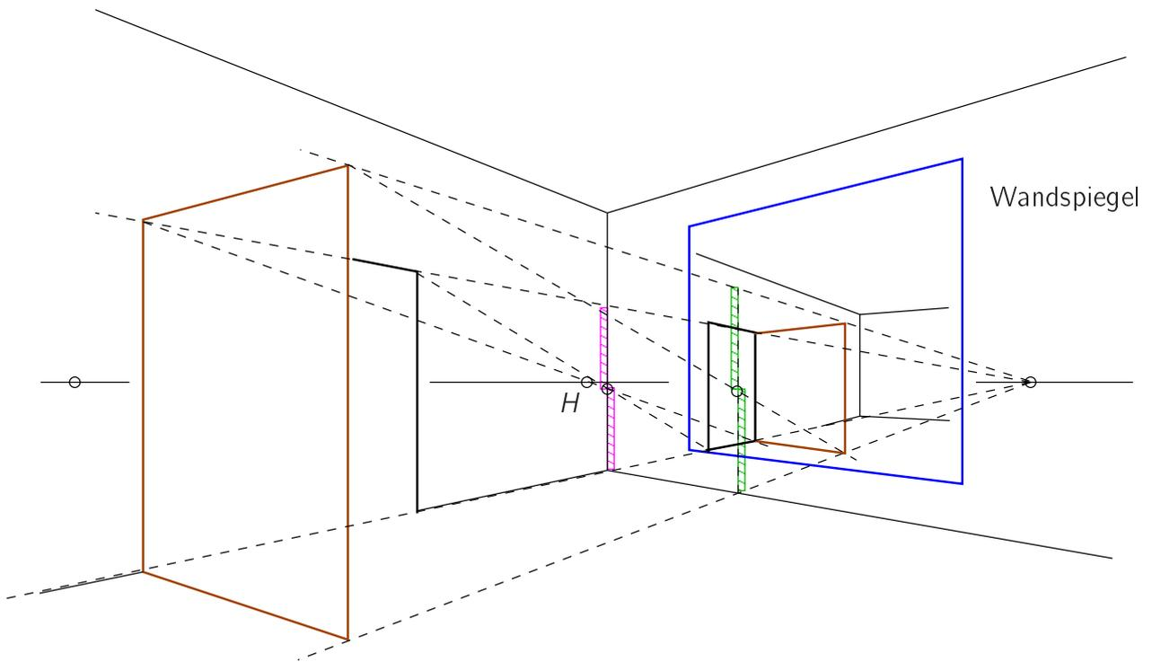
Abbildung 6.16: Zu Abb. 5.30: Spiegelung an einem Wandspiegel
