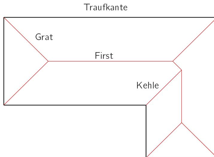
Abbildung 3.37: First, Grat- und Kehllinien eines Daches (Dachausmittlung)
