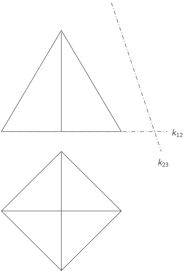
Abbildung 3.20: Umprojektion einer Pyramide (Grundriss wird ersetzt)
