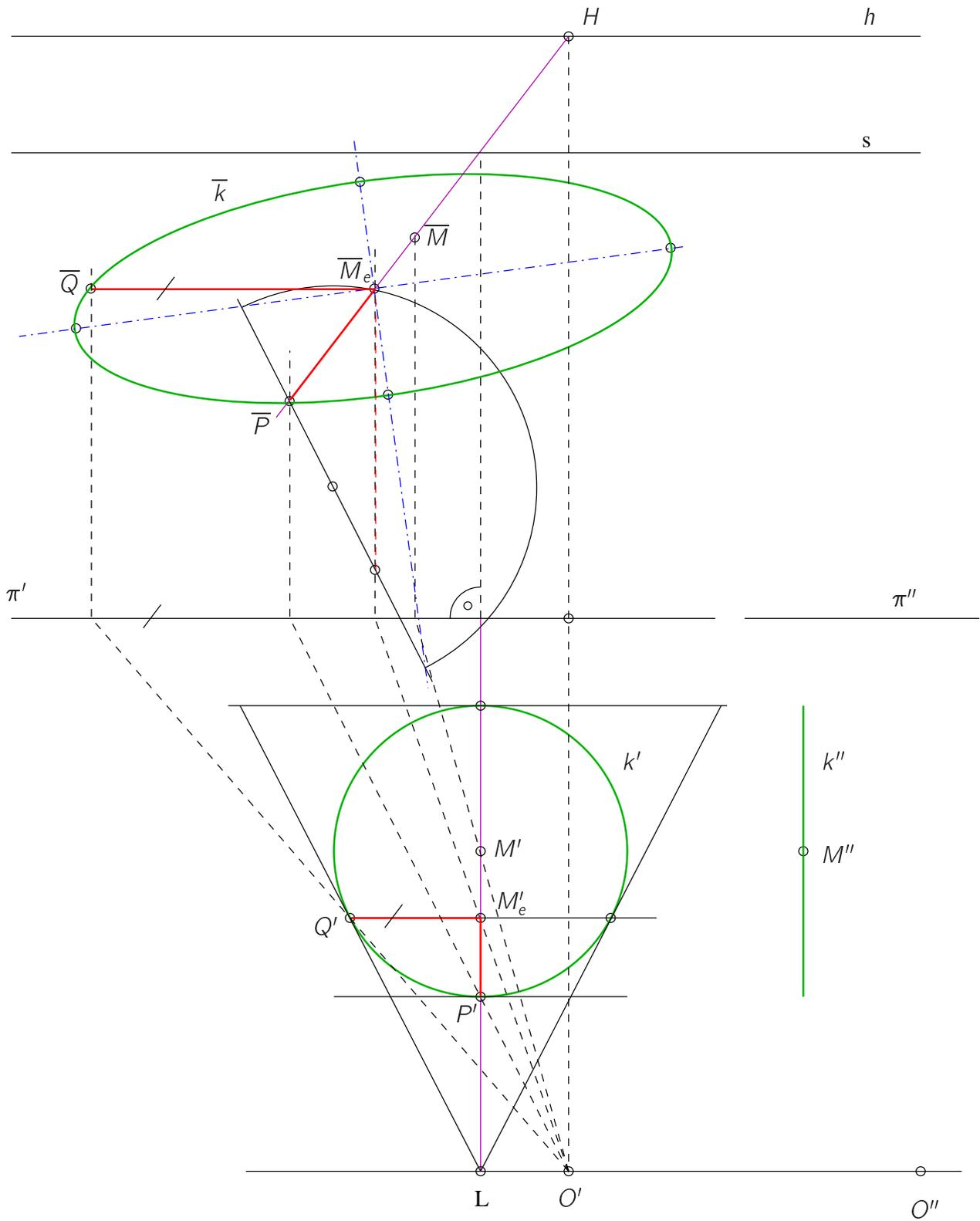
Abbildung 6.32: Zu Abb. 5.78 Projektion eines Kreises in der Standebene als Ellipse: Lösung
