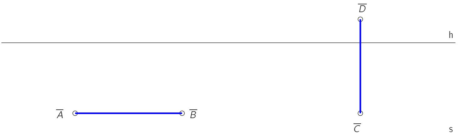
Abbildung 5.47: Bestimmung einer wahren horizontalen/senkrechten Länge:  $A, B, C$  liegen in der Standebene
