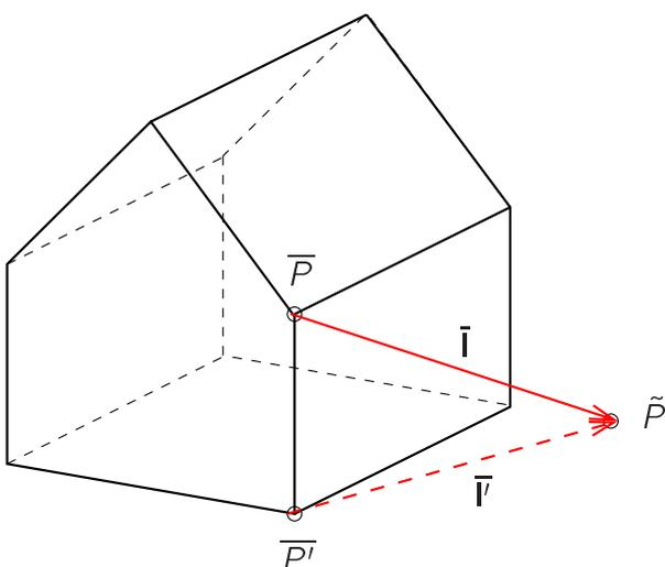
Abbildung 2.11: Schatten eines Hauses bei parallelem Licht
