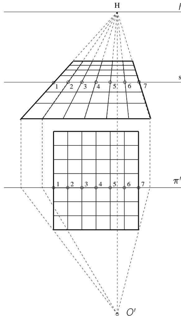
Abbildung 5.17: Konstruktion eines Netzes in der Standebene
