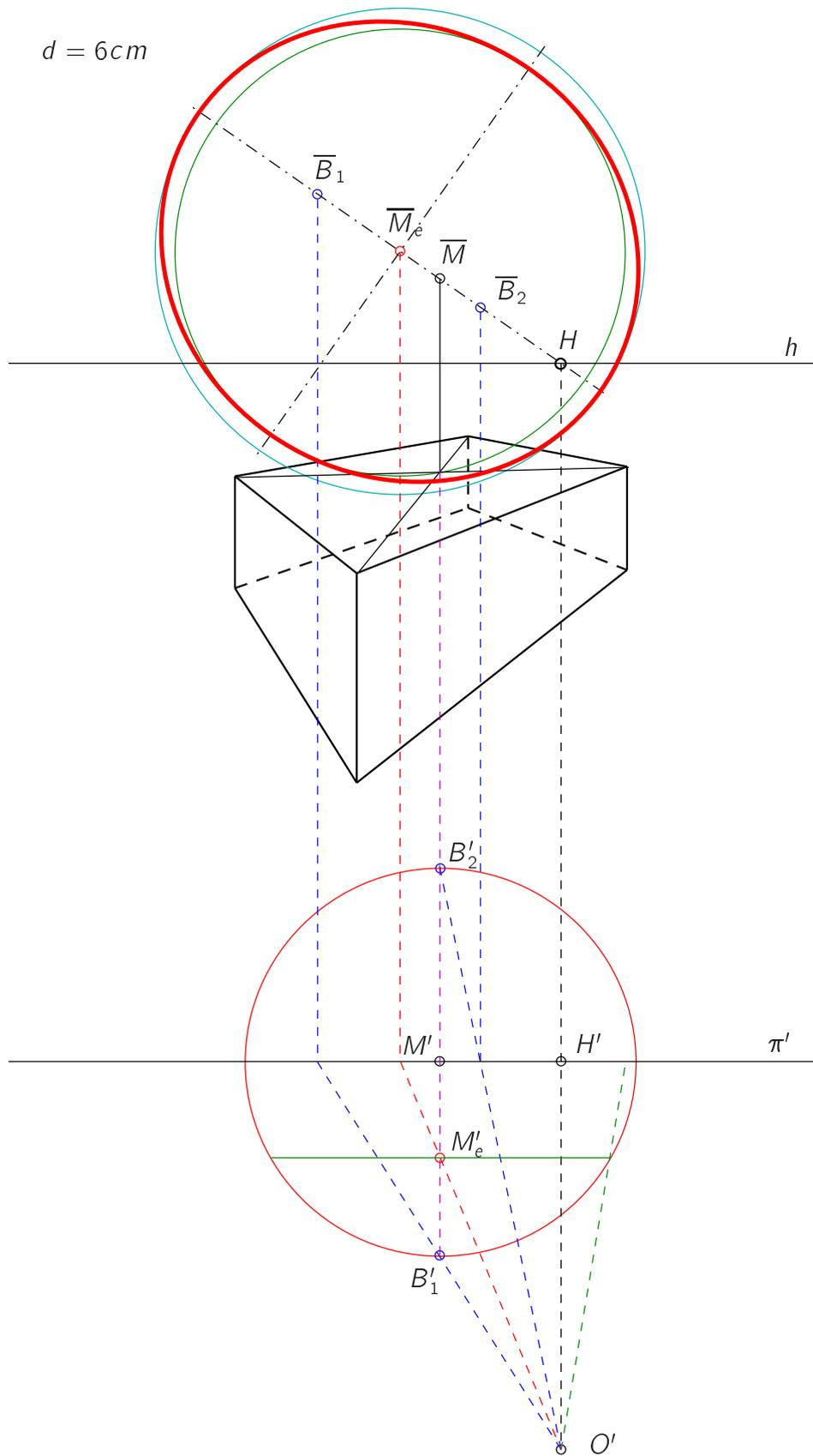
Abbildung 6.39: Zu Abb. 5.89 Konstruktion eines Kugelrisses im perspektiven Bild
