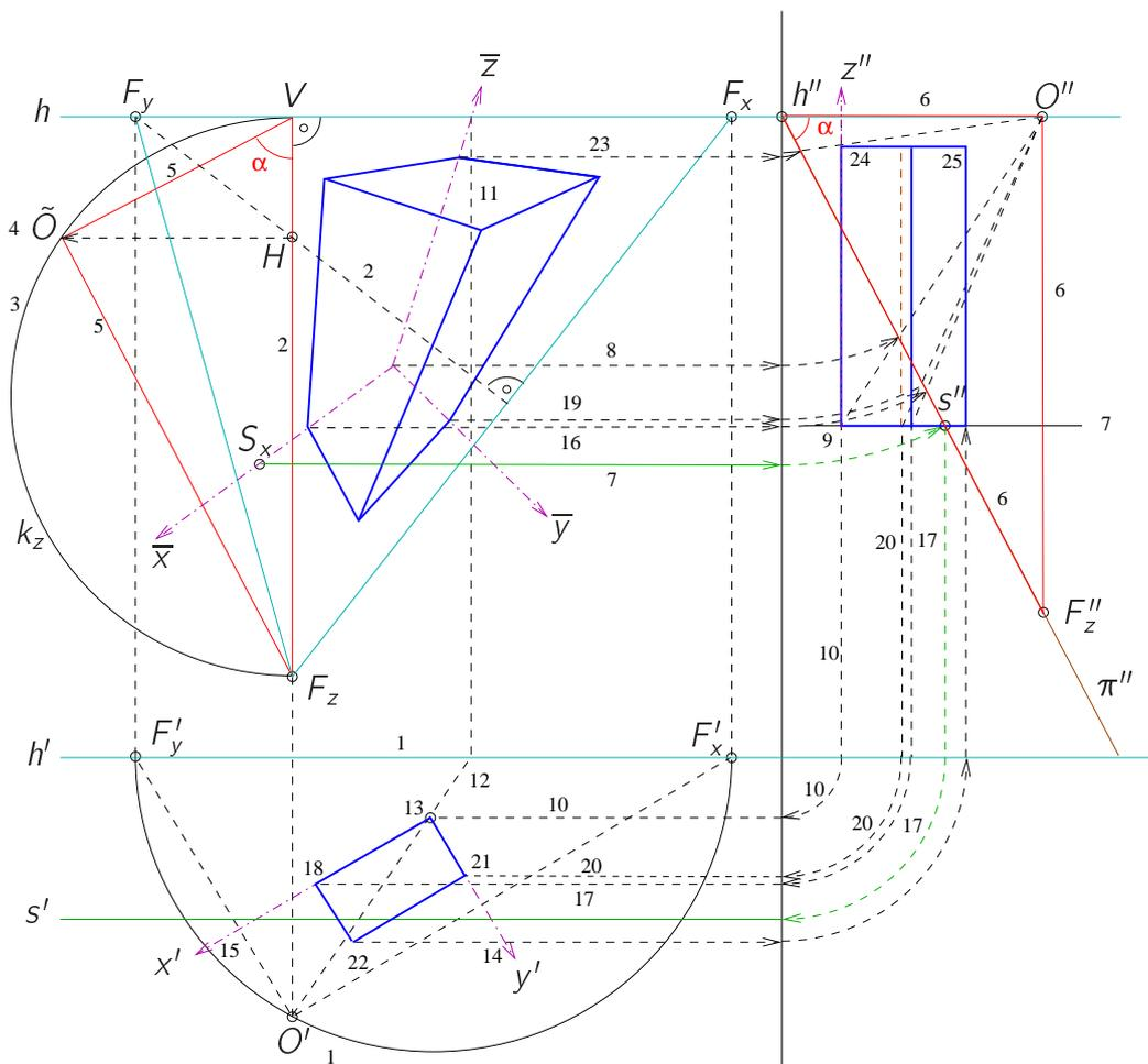
Abbildung 5.62: Zu Fig. 5.63 Rekonstruktion bei geneigter Bildtafel: Grund-, Aufriss eines Quaders
