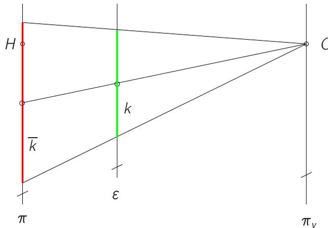
Abbildung 5.71: Zentralprojektion eines Kreises parallel zur Bildtafel
