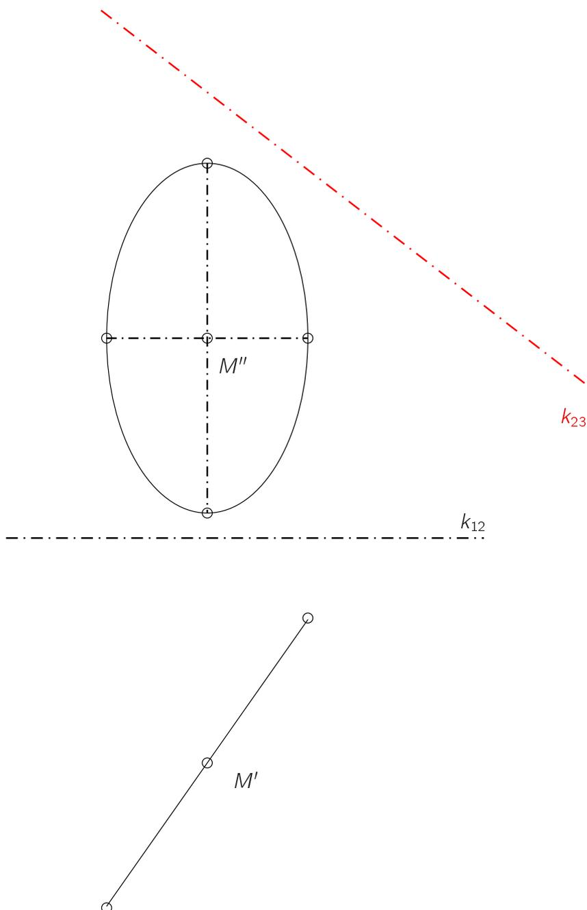
Abbildung 4.9: Umprojektion eines Kreises
