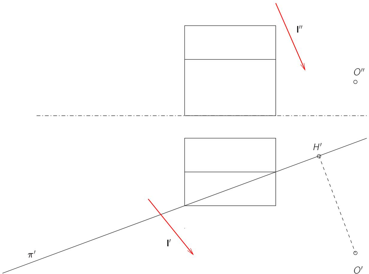
Abbildung 5.32: Schatten eines Hauses bei parallelem Licht
