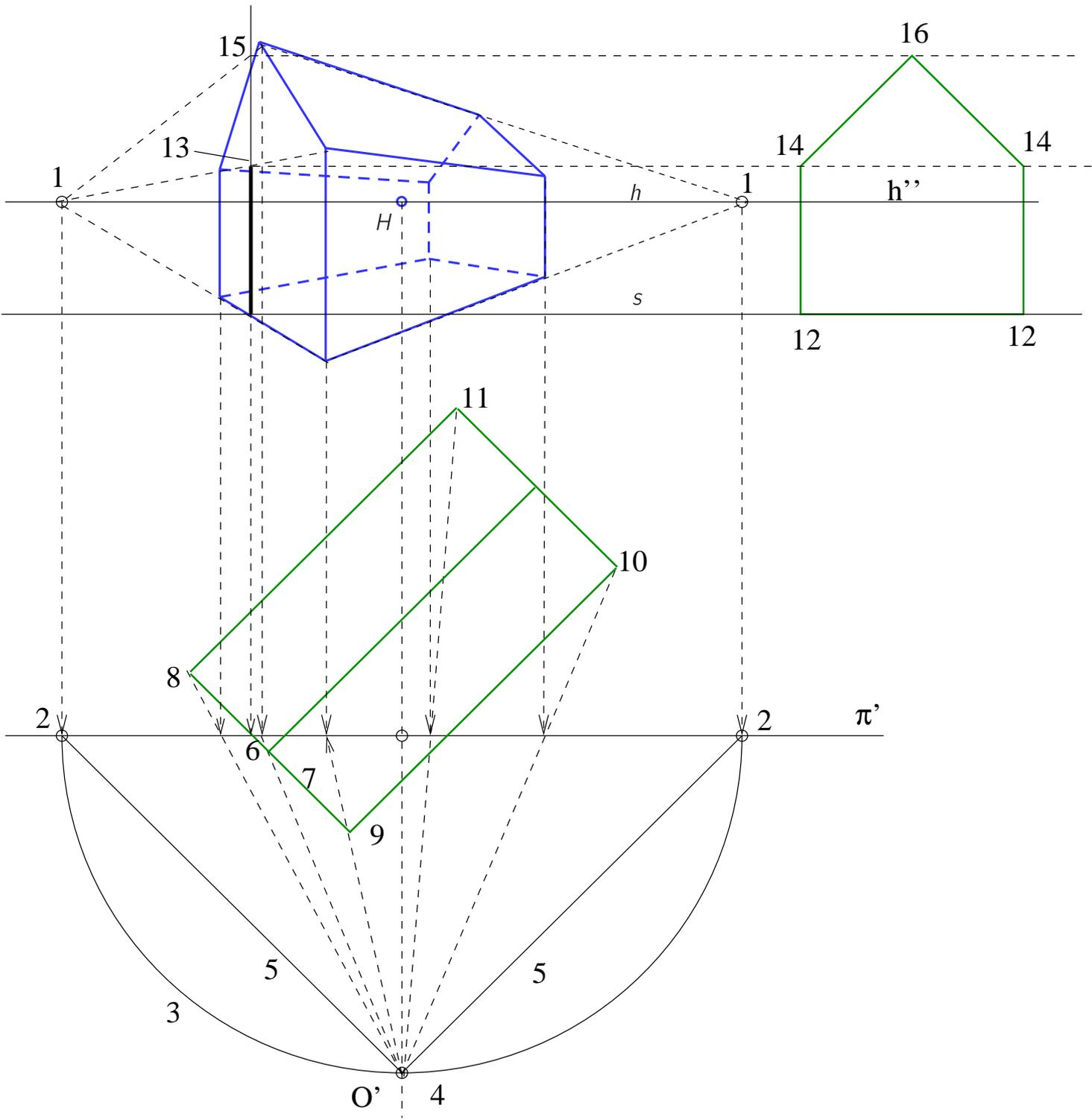
Abbildung 6.24: Zu Abb. 5.51 Rekonstruktion von Grund- und Aufriss eines Hauses
