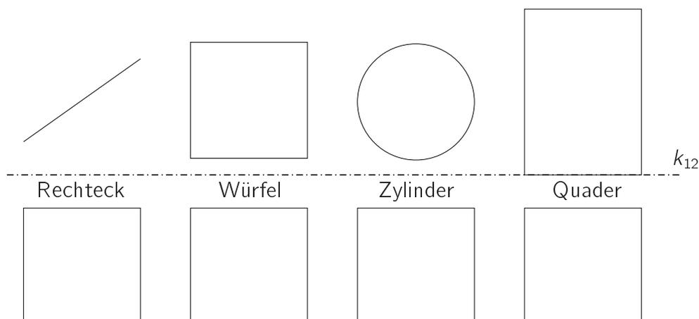
Abbildung 1.14: Verschiedene Objekte mit dem gleichen Grundriss
