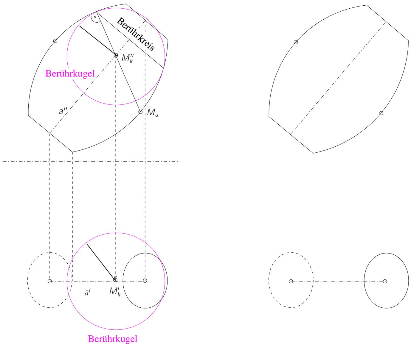
Abbildung 4.24: Umriss einer Rotationsfläche
