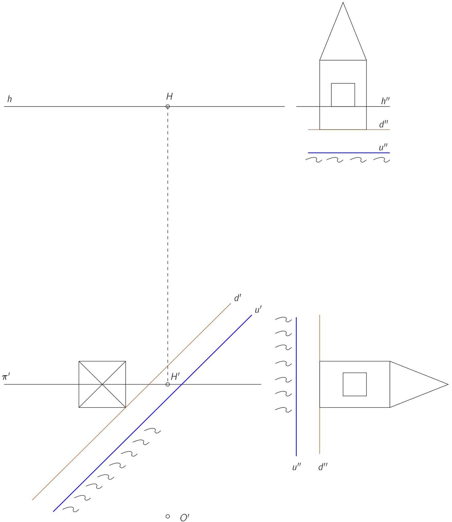
Abbildung 5.28: Spiegelung eines Turms an einer Wasseroberfläche
