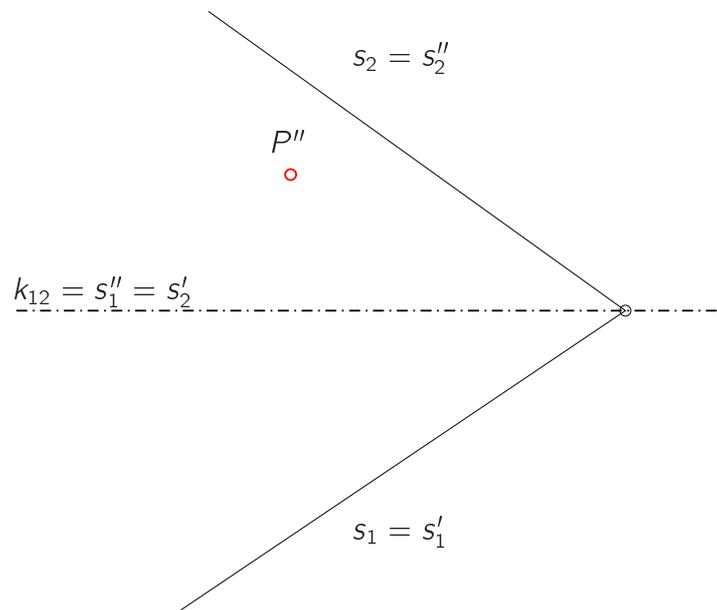
Abbildung 3.14: Punkt und Hauptgeraden in einer Ebene
