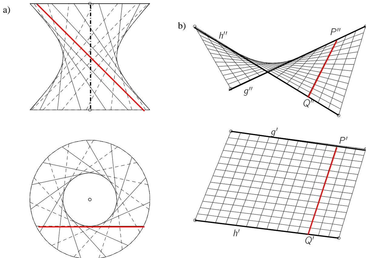
Abbildung 4.25: a) einschaliges Hyperboloid b) hyperbolisches Paraboloid
