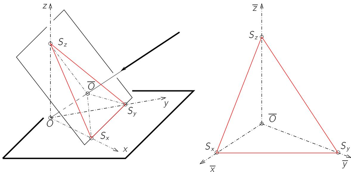
Abbildung 3.31: Senkrechte Axonometrie: Spurdreieck
