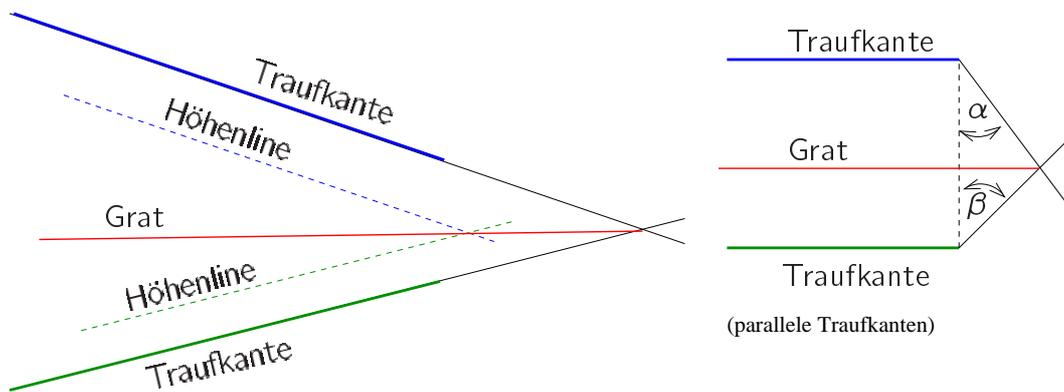
Abbildung 3.40: Konstruktionsprinzip einer Grat/Kehl-linie
