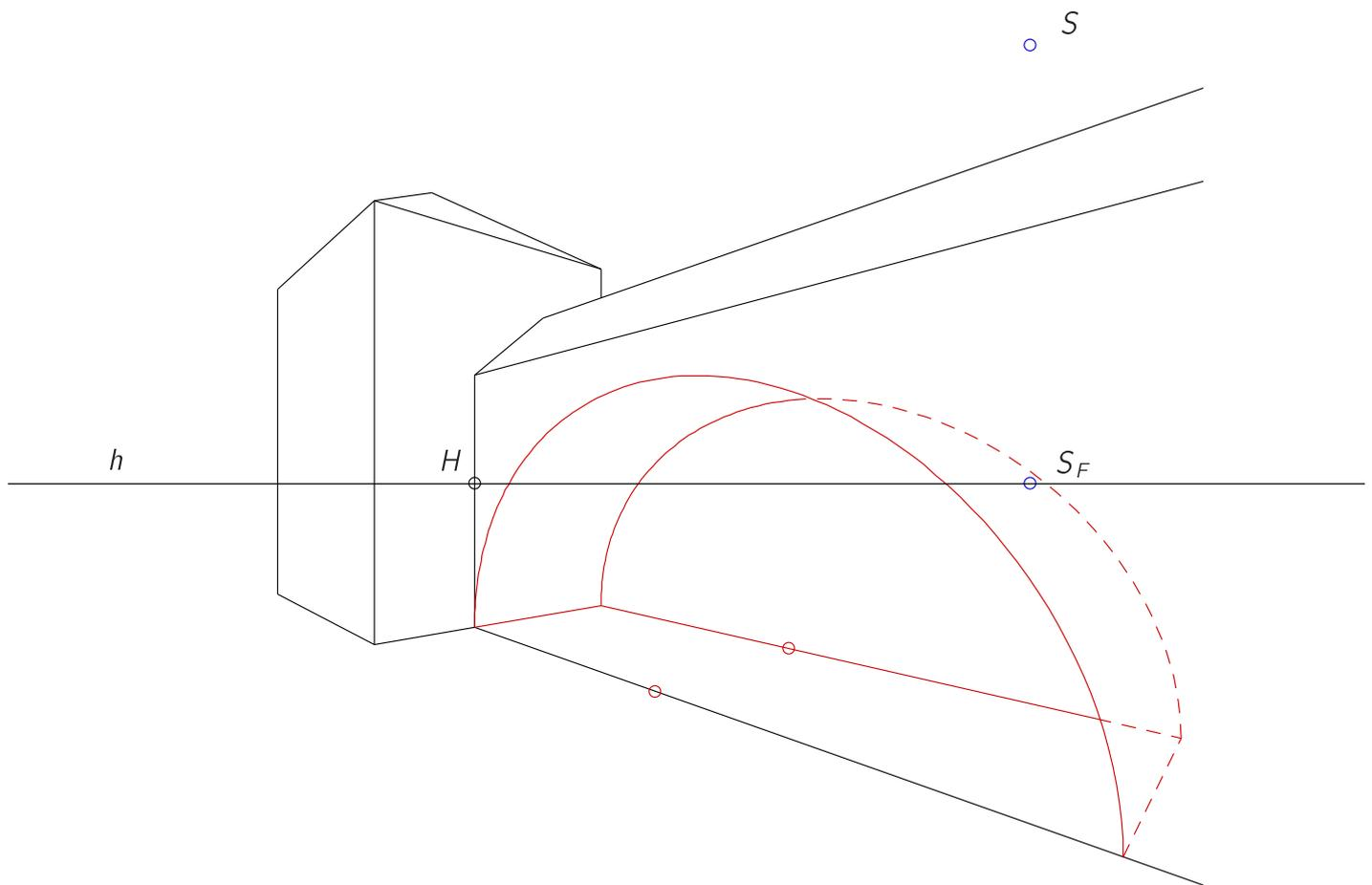
Abbildung 5.92: Schatten eines Torbogens bei gegebenem Sonnenlicht
