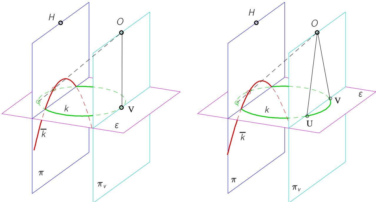
Abbildung 5.73: Zentralprojektion eines Kreises in der Standebene: Hyperbel/Parabel
