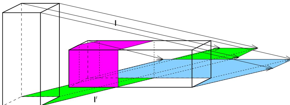
Abbildung 6.2: Zu 2.12: Schatten zweier Quader bei parallelem Licht
