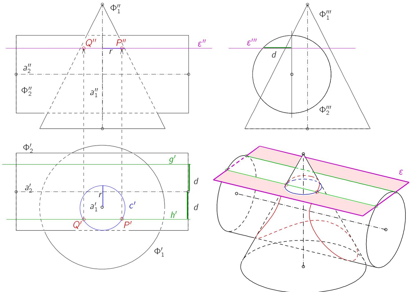
Abbildung 4.31: Schnitt: Kegel-Zylinder
