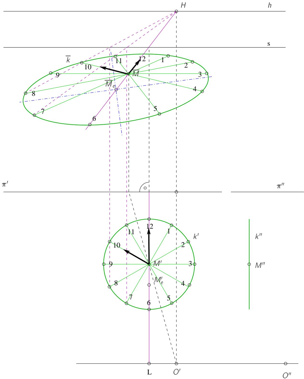
Abbildung 6.33: Zu Abb. 5.78 Projektion eines Kreises in der Standebene als Ellipse: Lösung
