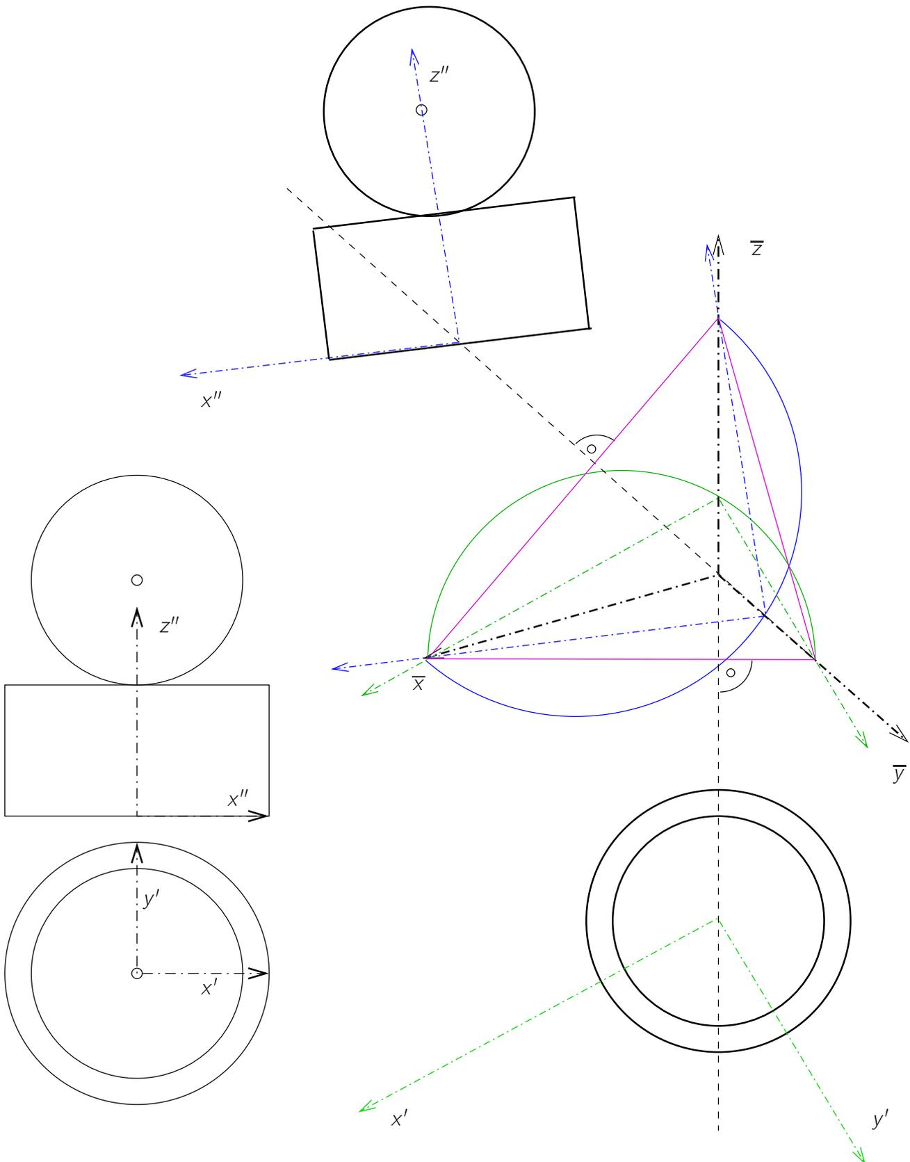
Abbildung 6.10: Zu Abb. 4.11: Zylinder mit Kugel in senkrechter Axonometrie
