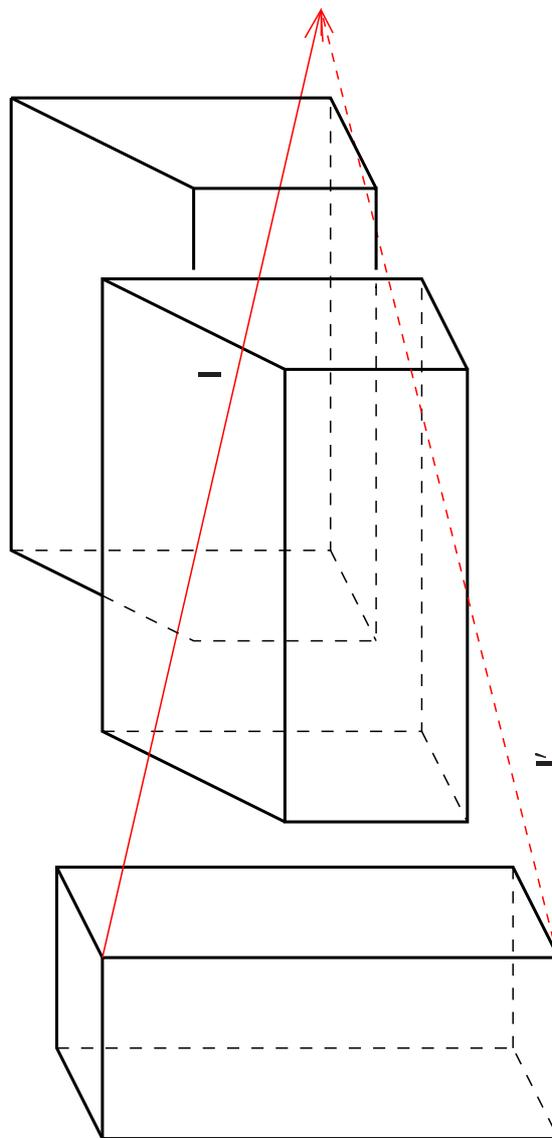
Abbildung 3.25: Schatten auf geneigte Ebenen bei parallelem Licht
