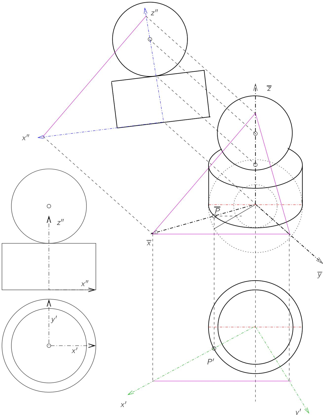
Abbildung 6.11: Zu Abb. 4.11: Zylinder mit Kugel in senkrechter Axonometrie
