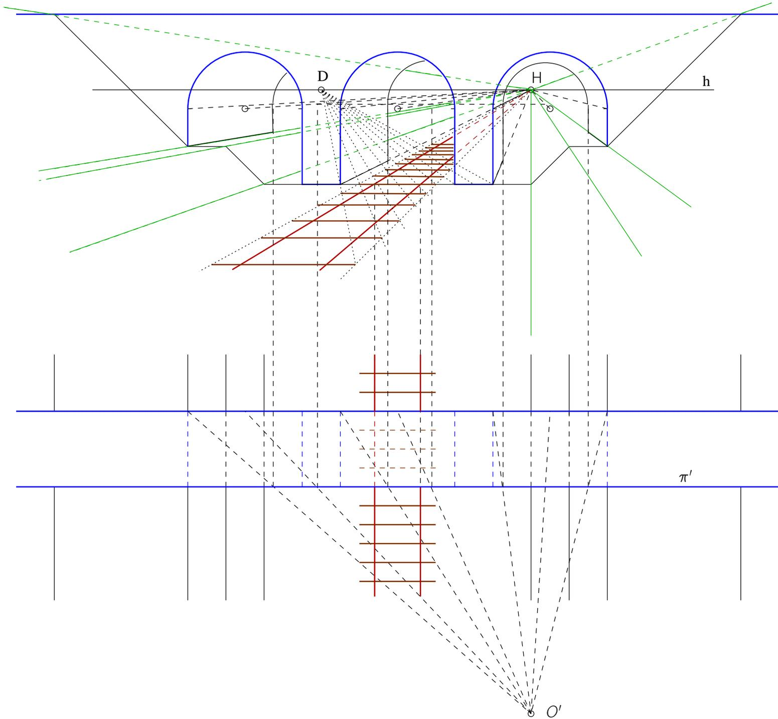
Abbildung 6.42: Zu 5.95 Frontalprojektion einer Brücke
