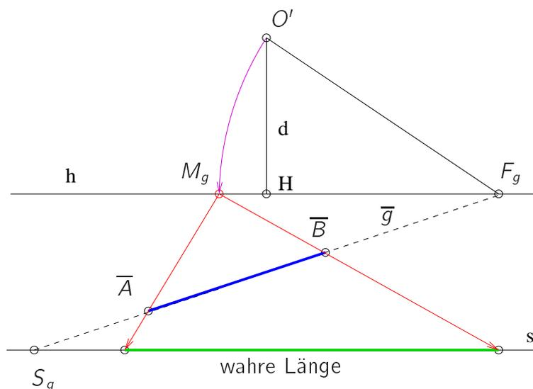
Abbildung 5.45: Bestimmung der wahren Länge einer Strecke
