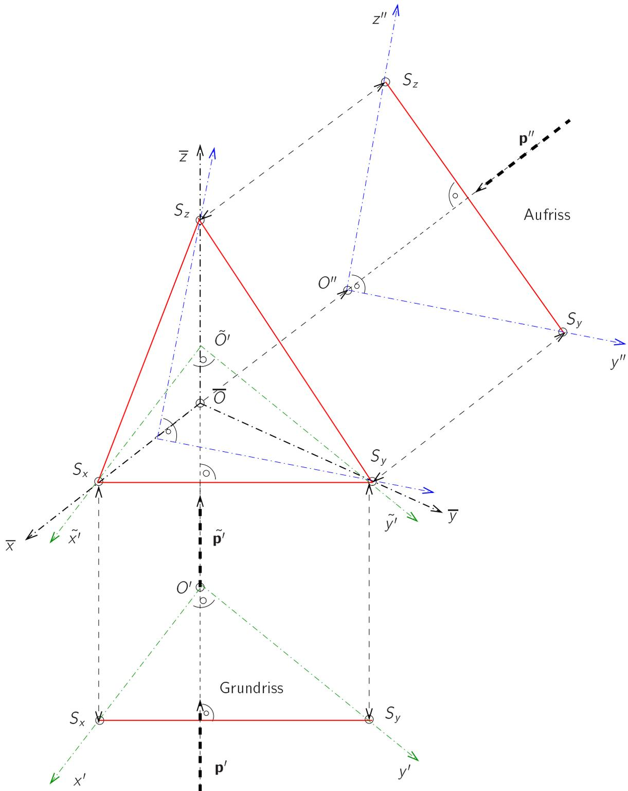
Abbildung 3.34: Senkrechte Axonometrie: Einschneideverfahren
