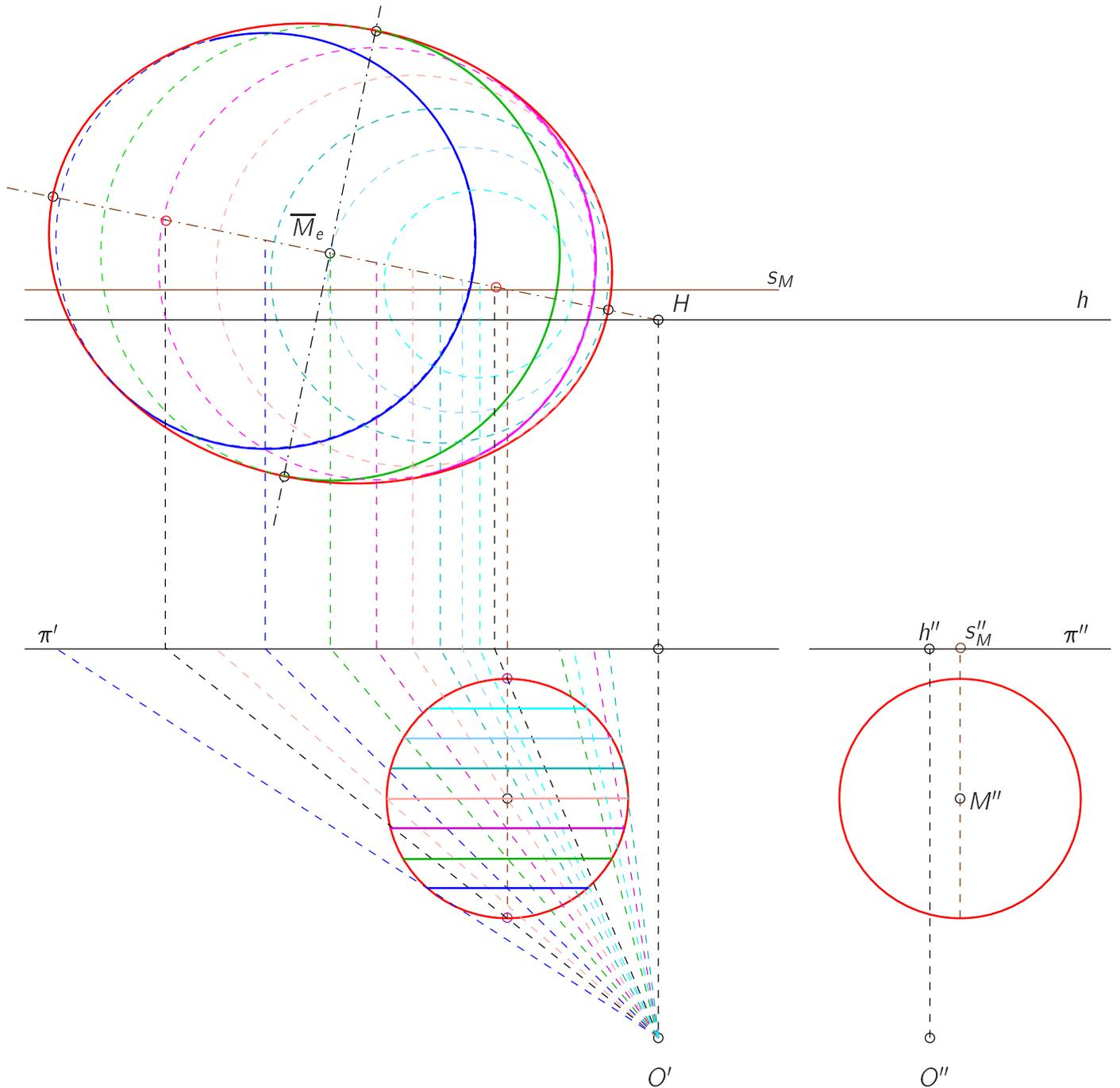
Abbildung 6.37: Zu. Abb. 5.84 Projektion des Umrisses einer Kugel als Ellipse
