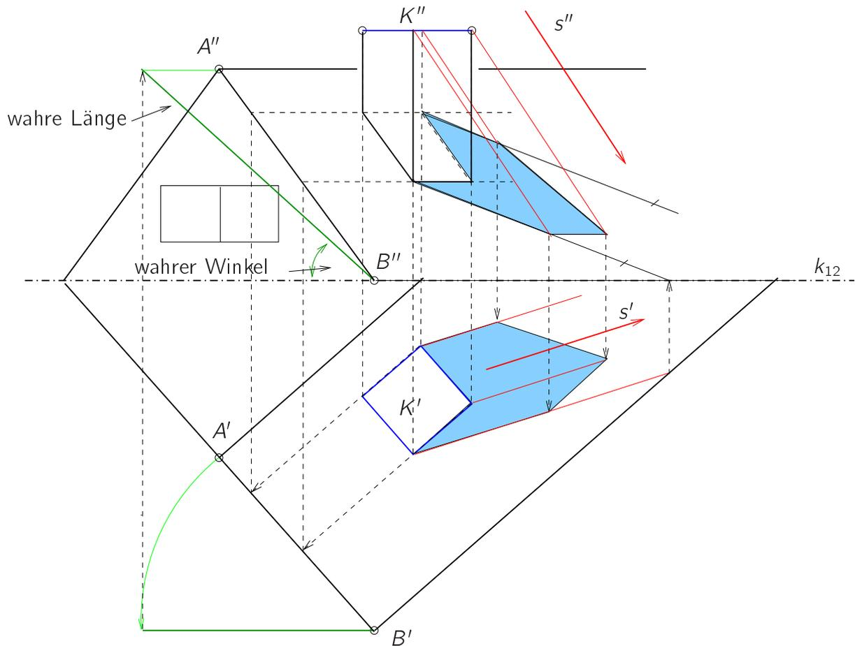
Abbildung 6.6: Zu Abb. 3.28: Schatten eines Kamins
