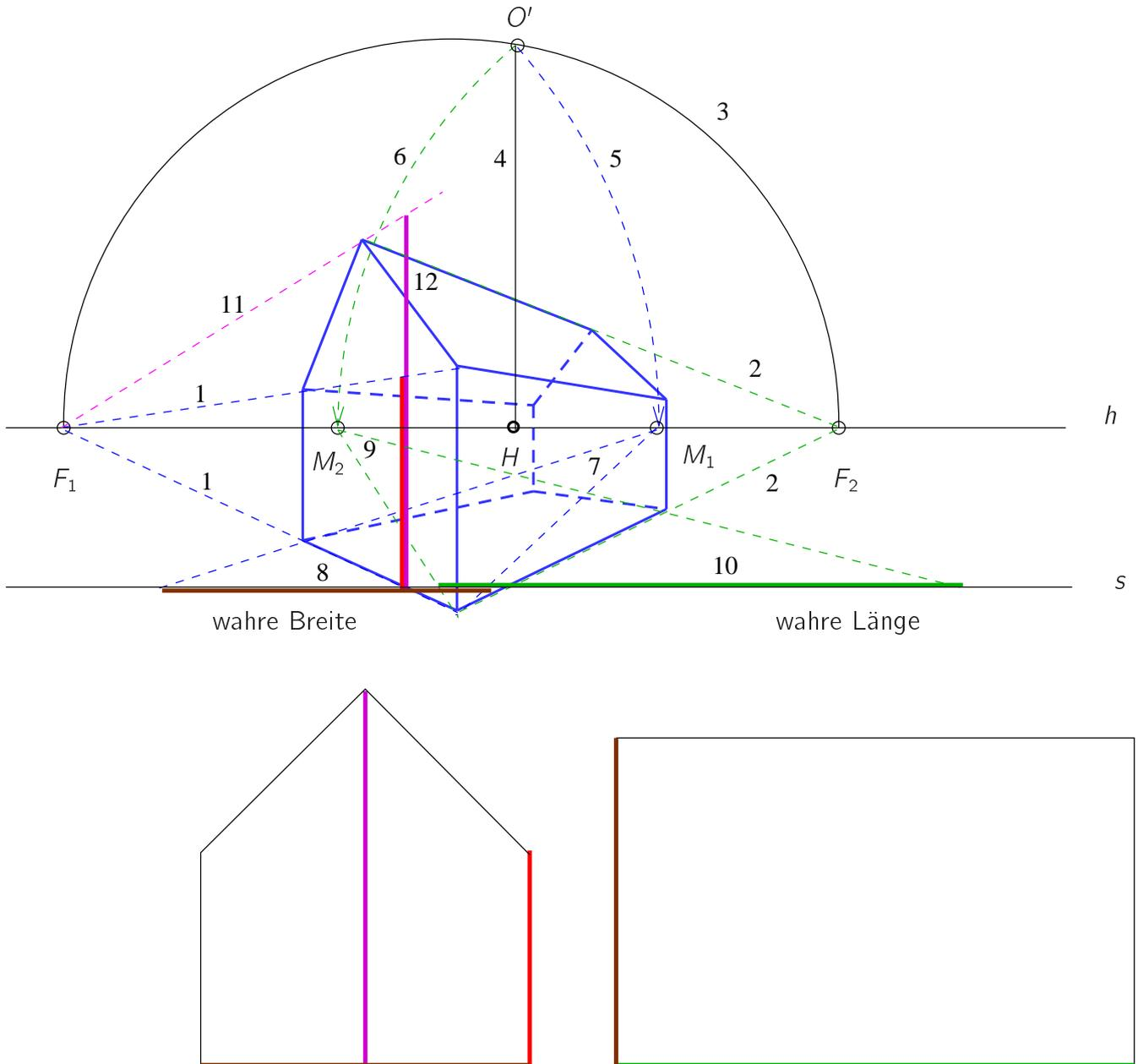
Abbildung 6.21: Zu Abb. 5.48: Bestimmung der wahren Abmessungen eines Hauses
