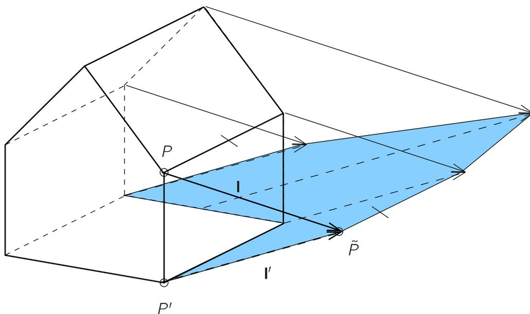
Abbildung 6.1: Zu Abb. 2.11: Schatten eines Hauses bei parallelem Licht
