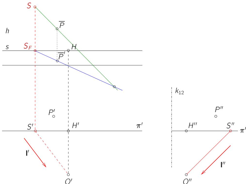
Abbildung 5.31: Schatten eines Punktes bei parallelem Licht
