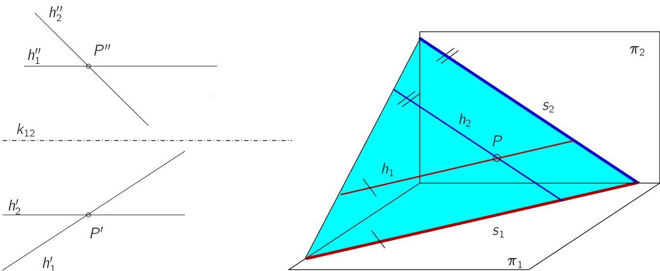
Abbildung 3.13: Spuren einer Ebene
