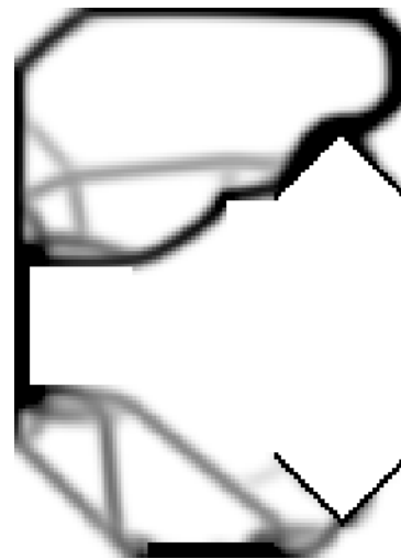
Abb. 2: Lösung der Topologieoptimierung. Die Graustufen stellen die Dichteverteilung des verwendeten Materials dar.
